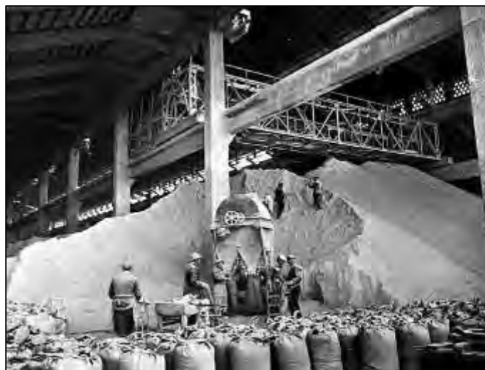
Figura 68. 1935 ca, fase di insaccamento del fertilizzante (fonte: foto Ancilotti e Martinotti, Archivio Montedison Milano in D. Resini 2004, n. 00001530)
