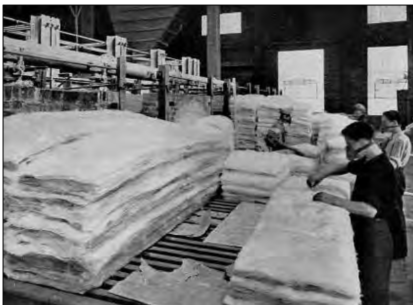
Figura 22. 1938, stabilimento Vetrocokes, il reparto per la produzione della lana di vetro (fonte: http://digilander.libero.it/trombealvento/varii/rayon1territorio.htm )
