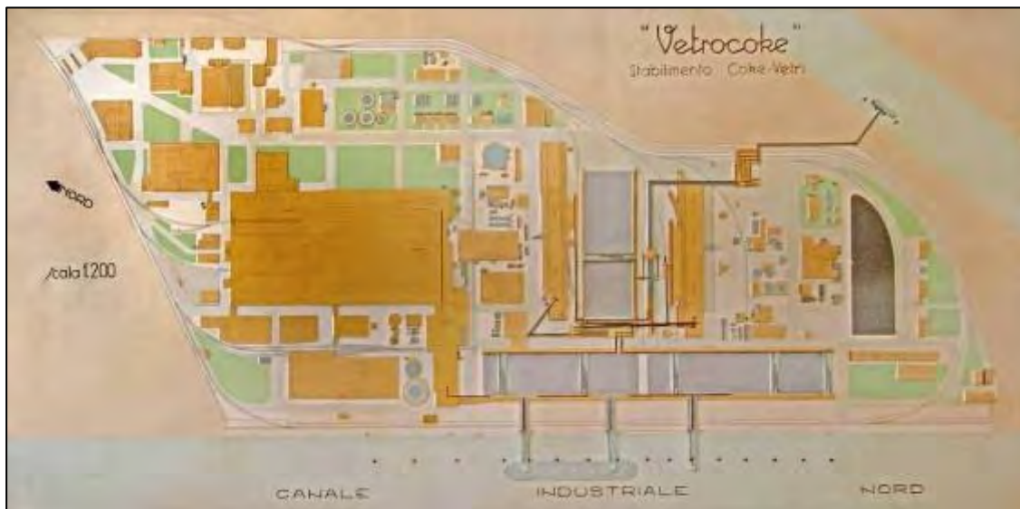
Figura 59. Anni '50 planimetria dello stabilimento Vetrocoke per la distillazione di coke e la produzione di vetro (fonte: foto del pannello conservato all'interno dello stabilimento, ora Pilkington)
