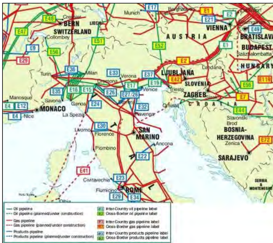
Figura 45. Mappa delle pipelines tra Italia, Svizzera e Austria, per il trasporto di petrolio, gas e altri prodotti (benzina, etilene, ecc.) (fonte: http://www.theodora.com/pipelines/italy_switzerland_and_austria_pipelines.html )
