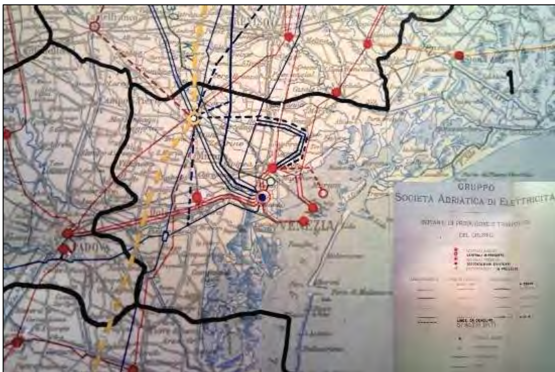
Figura 46b. Impianti di produzione e trasporto energia elettrica al 1948 (fonte: Società Termoelettrica Veneta, Relazione per domanda di finanziamento ERP , ACS)
