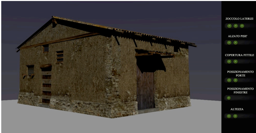
Figura 132 Esempio di indice di affidabilità inserito a fianco di ogni ipotesi ricostruttiva. (Da tesi specialistica di I. Carpanese 2012)
