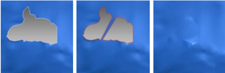
Figura 4.11: sulla superficie triangolata spesso possono essere presenti buchi o lacune; l’operazione di Fill Holes consente di chiudere le lacune, evidenziate nel modello in rosso, costruendo una struttura poligonale che segue l’andamento della superficie al fine di ottenere un layout organizzato e continuo.
