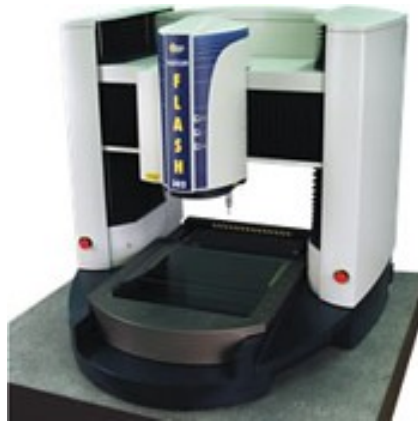
Figura 3.15: OGP SmartScope Flash CNC 300, sistema multisensor che può essere configurato per acquisizione ad immagine, TTL laser a triangolazione, a contatto (immagine tratta da www.ogpitalia.it ). 22
