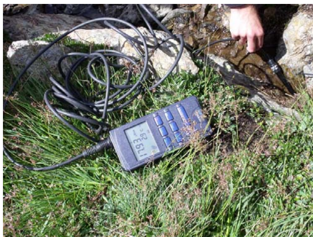
Figura 23. Conduttivimetro utilizzato per le misure di conduttività delle acque.
