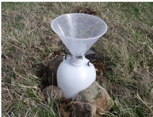
Figura 37. Recipiente con imbuto per la raccolta di piogge nel lungo periodo.
