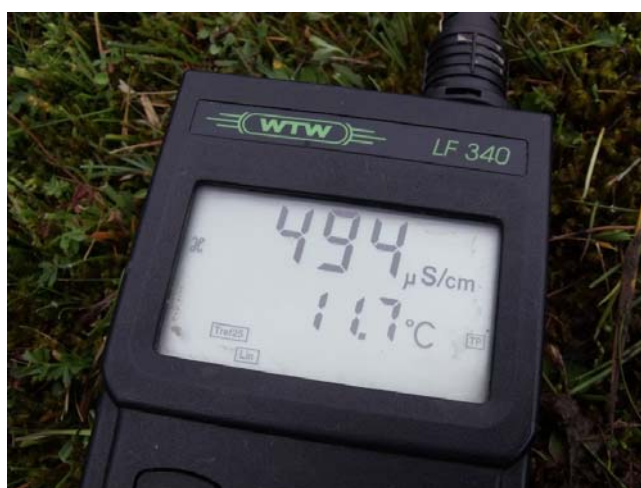
Figura 24. Display del conduttivimetro con i valori di conducibilità in \mu\text{S}/\text{cm} .
