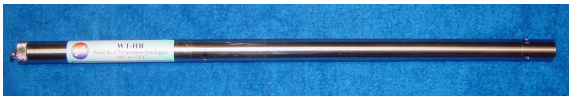
Figura 14. Sonda capacitiva del piezometro.
