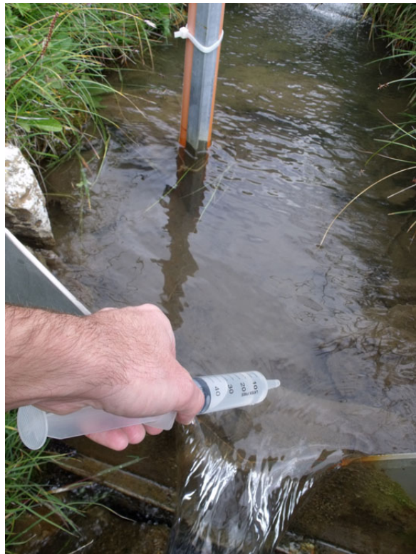
Figura 42. Prelievo di acqua dal Rio Ponte in corrispondenza del vertice dello stramazzo.
