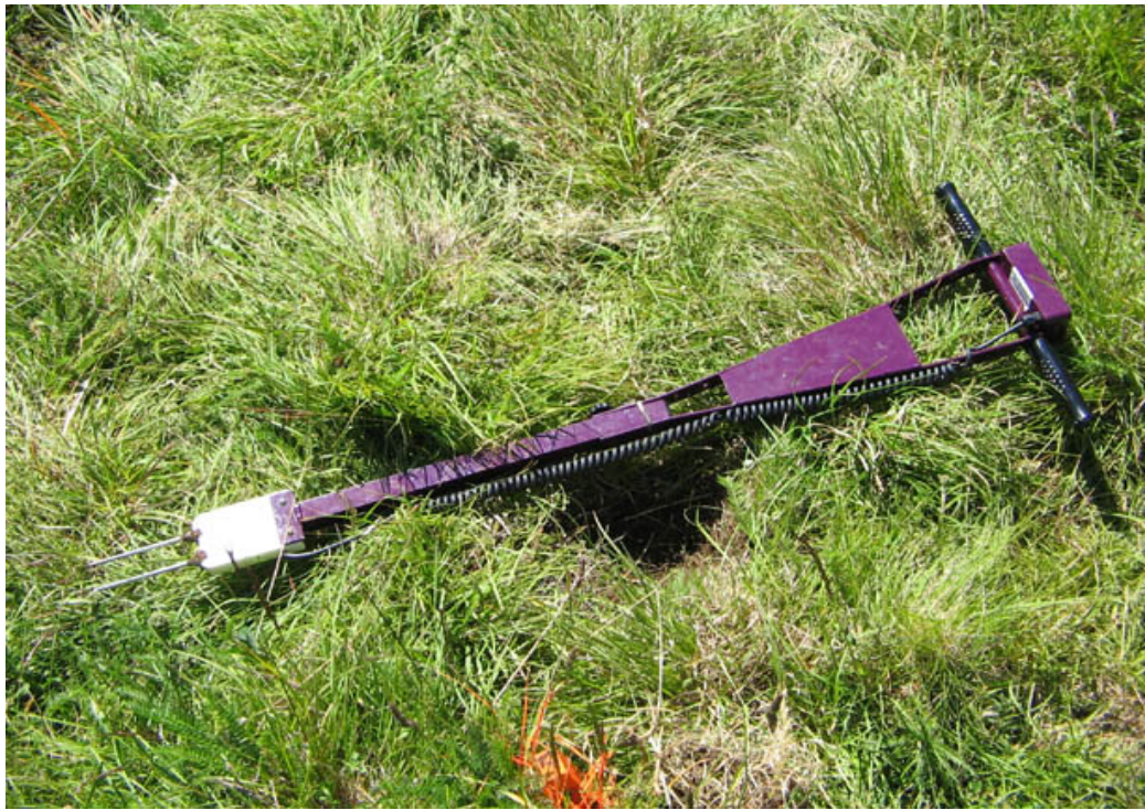
Figura 21. TDR300 equipaggiato con gli elettrodi lunghi 20 cm.
