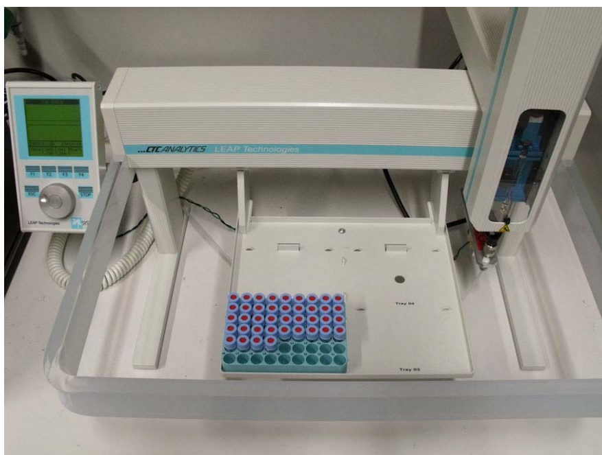
Figura 44. Autocampionatore della CTC Analytics con un vassoio di campioni.
