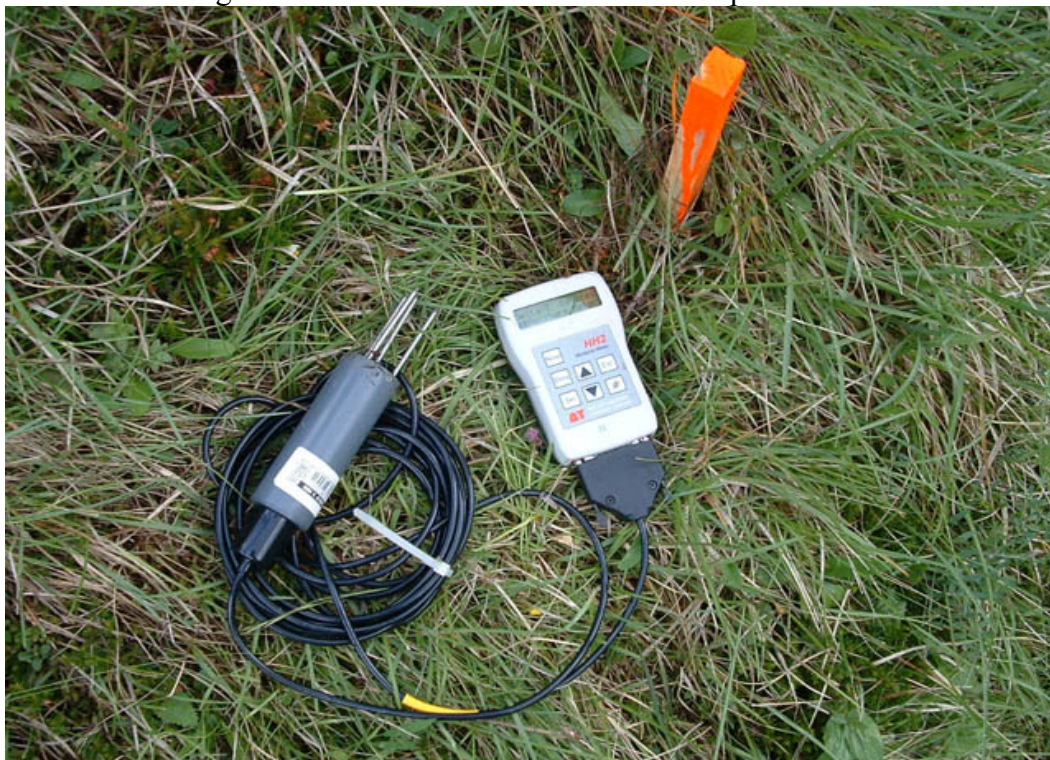
Figura 20. La sonda ThetaProbe.
