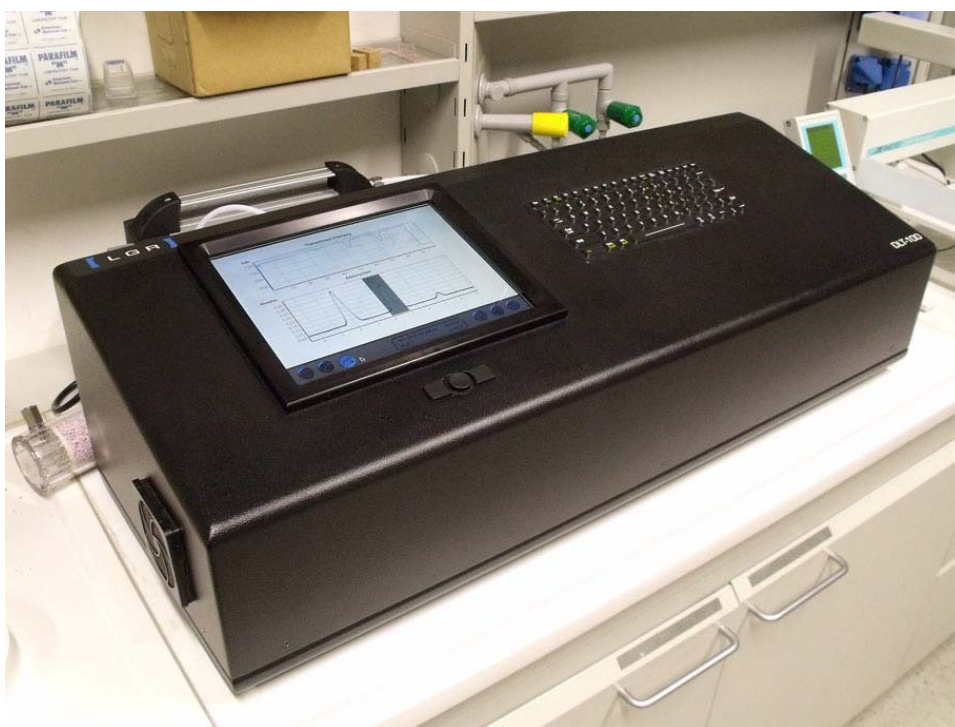
Figura 43. Analizzatore LGR degli isotopi dell'acqua presso il TESAF, modello DLT-100.
