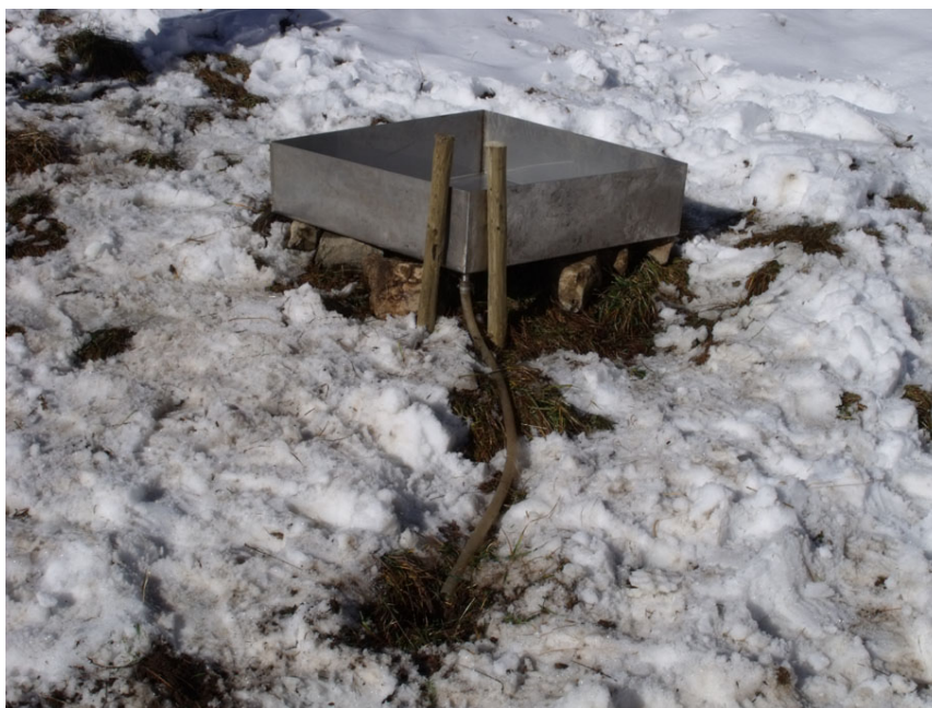
Figura 40. Uno dei due lisimetri installati sulla destra idrografica del Rio Ponte per il monitoraggio dell'acqua di fusione nivale.
