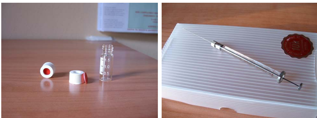
Figura 45. Tappi con setti e fiale (sinistra) e siringa (destra) usati per le analisi di laboratorio.
