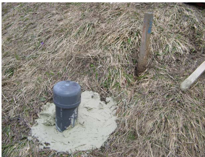
Figura 15. Esempio di piezometro bentonizzato.
