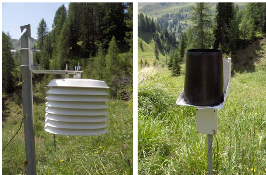
Figura 10. Termometro (sinistra) e pluviometro a bilancia (destra).
