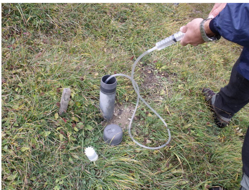
Figura 41. Esempio di un prelievo di acqua di falda dal pozzo piezometrico.
