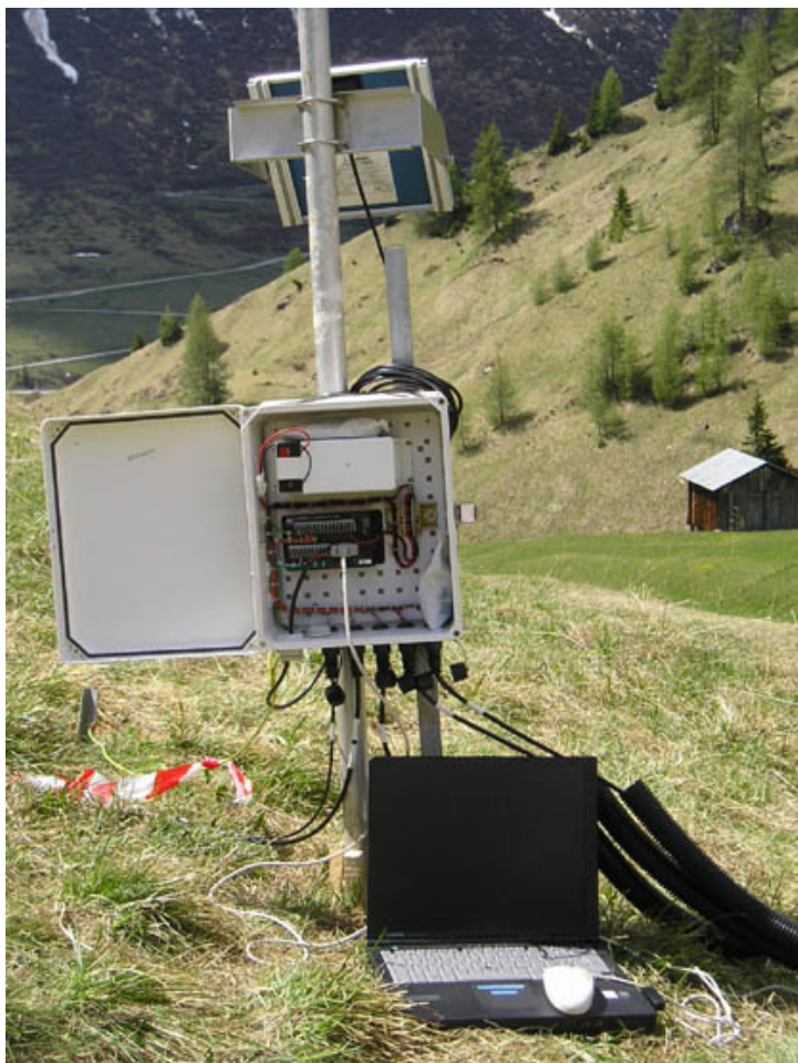
Figura 16. Riflettometro CS625 (aperto e collegato ad un PC portatile per lo scarico dei dati).
