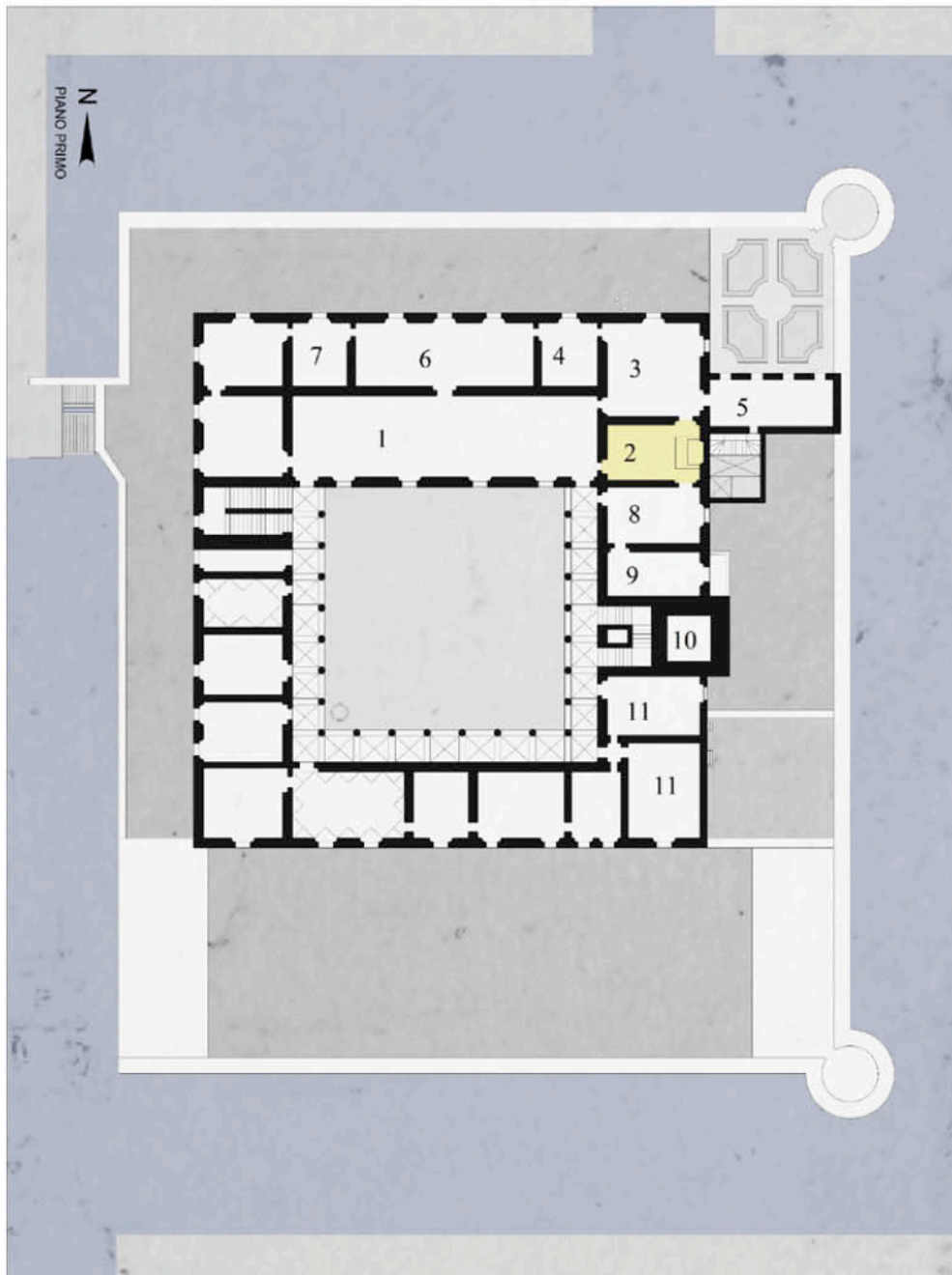
35. Ipotesi ricostruttiva del piano nobile di palazzo Pallavicino (elaborazione dell'autore). 1. Sala magna superiore, 2. Cappella, 3. Camera del Lauro superiore, 4. Guardacamera, 5. Studio, 6. Saletta superiore, 7. Camera del Montone, 8. Camera di Laura Caterina Landi, 9. Camera con loggetta, 10. Torre, 11. Camere sopra il «locum bugate».
