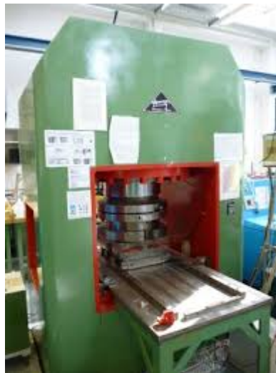
Fig. 15 – Hymag-multi-anvil press at the Bayerisches Geoinstitut.
