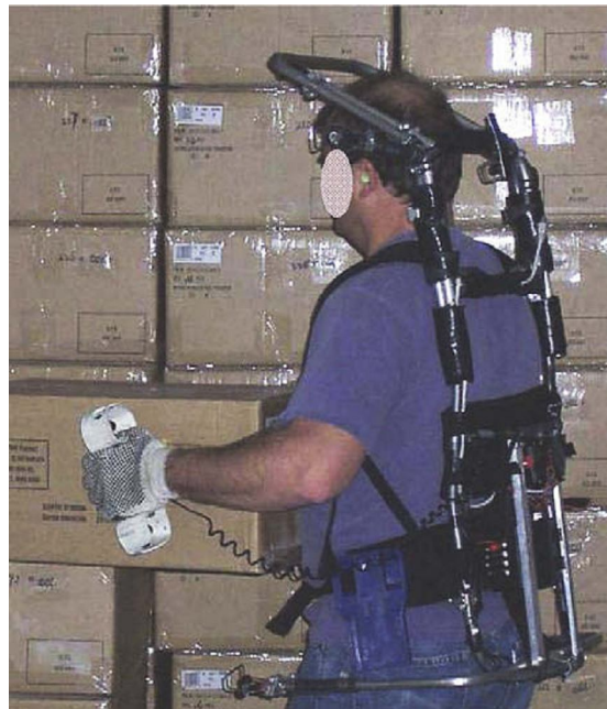
Figura 4 - Soggetto che indossa la strumentazione usata per monitorare sul posto di lavoro gli effetti dell'esposizione fisica (Marras et al., 2010).
