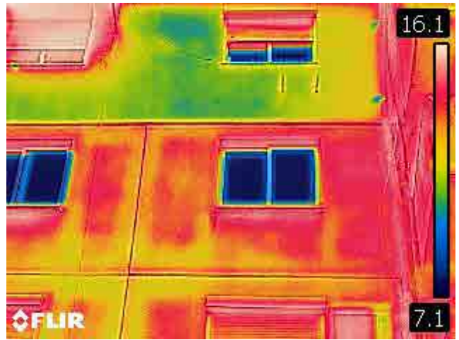
Figura 24. Temperatura della facciata con e senza isolamento. Rilievo del 12.01.2018 ore 15:00
