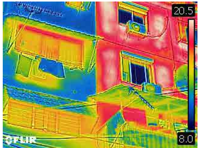
Figura 25. Temperatura della facciata Sud-Est con e senza isolamento. Rilievo del 12.01.2018 ore 9:00.
