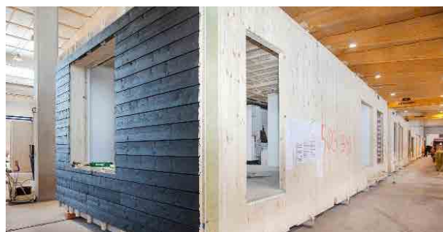
Figura 28. (a) Edificio esistente e l'uso dei moduli prefabbricati; (b) fabbricazione dei moduli CLT [Soikkeli 2016]
