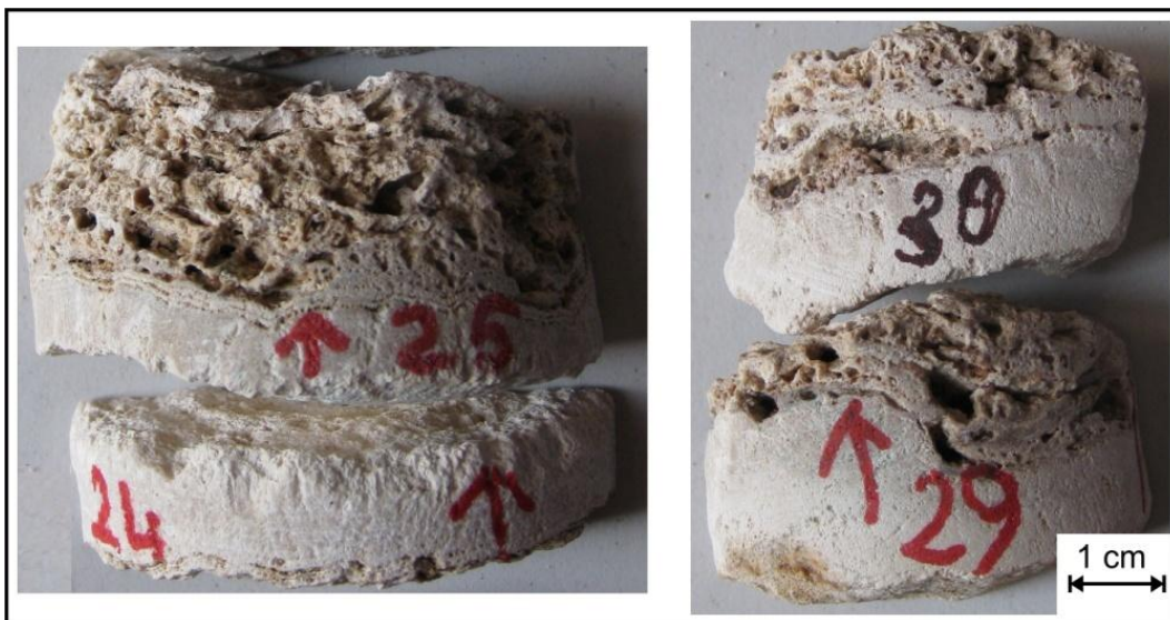
Fig. 3.21: particolare delle breccie intraformazionali riscontrate durante il carotaggio.
