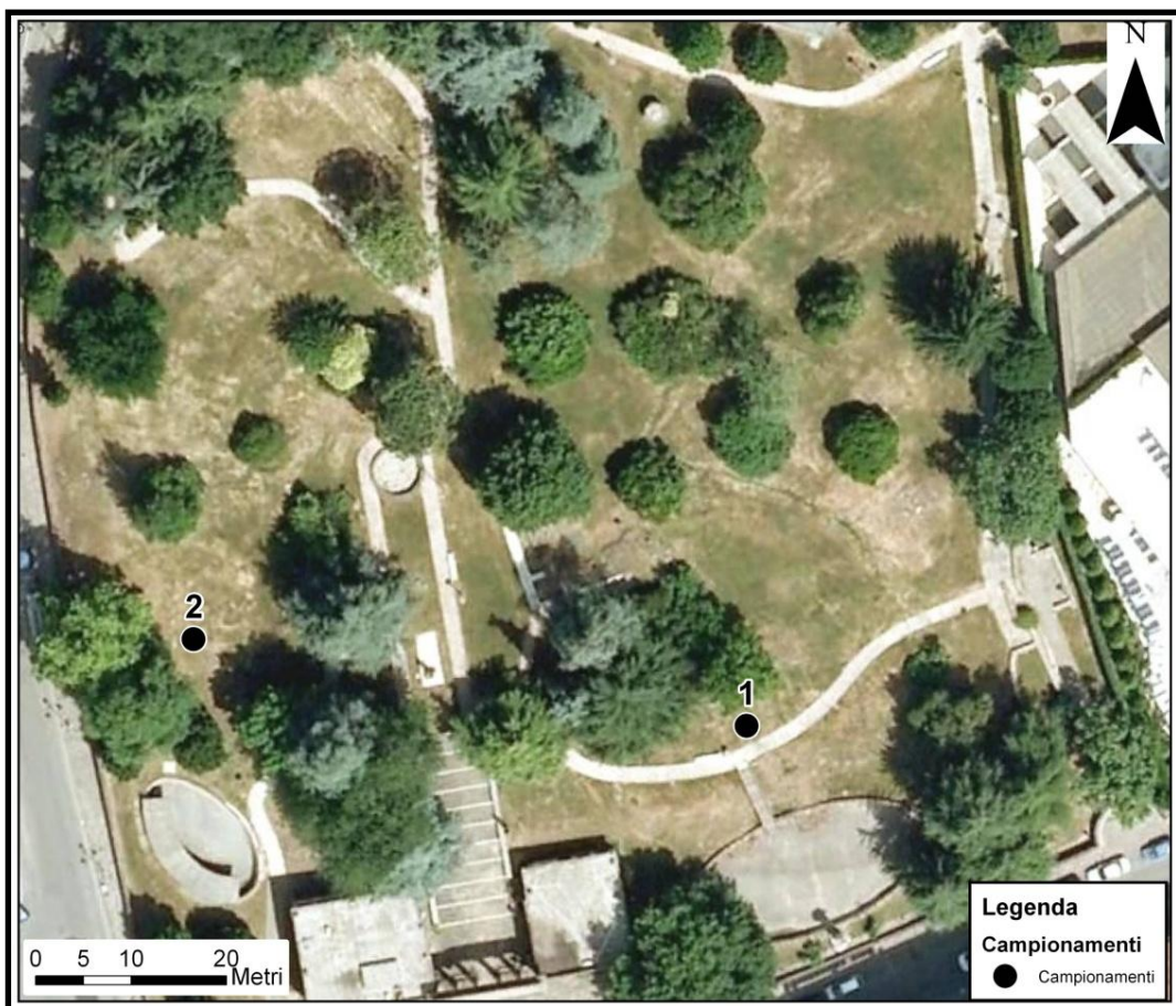
Fig. 3.6: ubicazione dei carotaggi effettuati per campionare il travertino. Il carotaggio 1 si trova sulla cima del colle a una quota di circa 14 m s.l.m. mentre il carotaggio 2 si trova sul lato O a una quota di 12.80 m s.l.m. .
