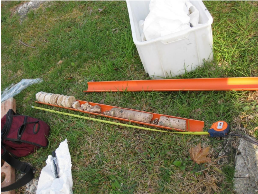
Fig. 3.20: immagine della carota 2 prelevata sul lato occidentale del colle del Montirone ad una quota di 12.80 m.s.l.m.
