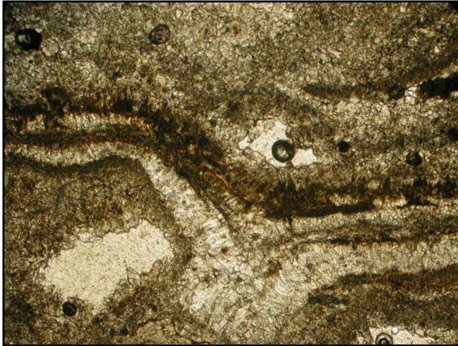
Fig. 3.17: particolare della Fig. 3.16; lo strato di tetto, a taglia cristallina più grossolana (chiaro), è più competente e si deforma in modo fragile mentre il sedimento fangoso a grana fine (scuro) si deforma in modo duttile, risalendo nelle cavità lasciate dallo strato di tetto.
