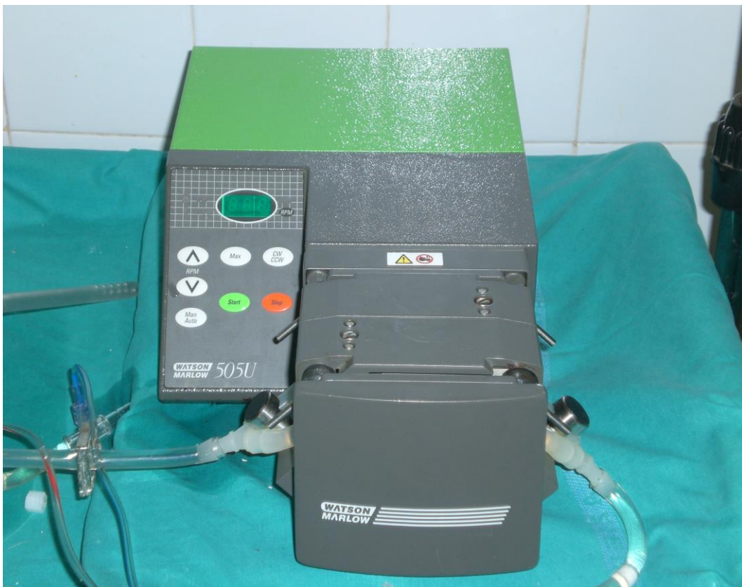
Foto 6: pompa volumetrica rotativa Watson Marlow 505
