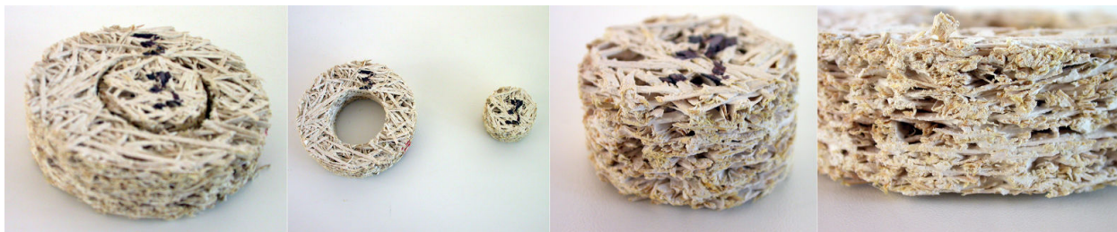
Figura 12-1: Preparazione dei provini di lana di legno mineralizzata;
