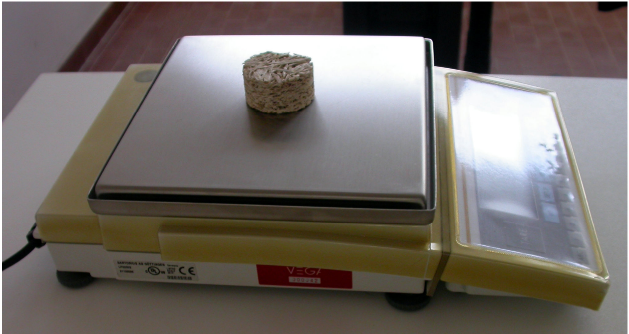
Figura 12-2: Misura della densità della lana di legno mineralizzata
