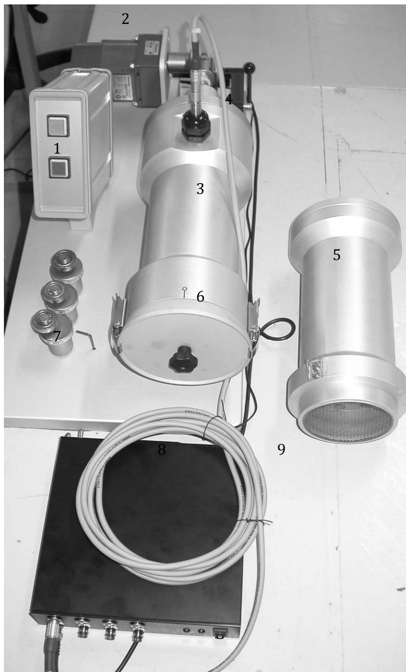
Figura 3 – Set-up di misura: il sistema è composto da diverse parti, di cui alcuni apparati elettronici ed altri meccanici: Si può notare il controllore di velocità del motoriduttore (1) il motoriduttore con albero a camma (2), il microfono con preamplificatore (4), l'alimentatore microfonico (8) ed il cavo LEMO microfonico (9), il sistema meccanico principale con la camera di misura (3), il porta-campione (5), tre camme sostitutive (7) (la quarta è montata sull'albero motore del sistema (2)), il tappo di calibrazione (6)
