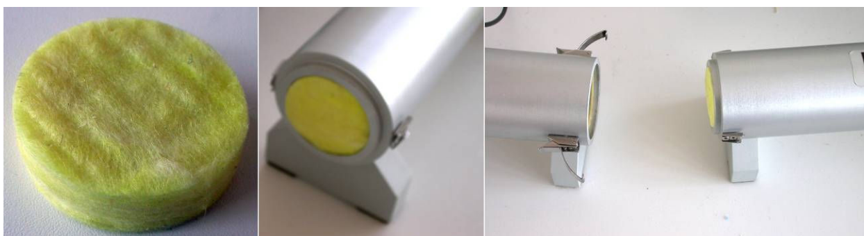
Figura 11-1: Misura del coefficiente di assorbimento di un provino di lana di vetro con densità 70 \text{ kg/m}^3 , di diametro 45 mm e spessore 15 mm.
