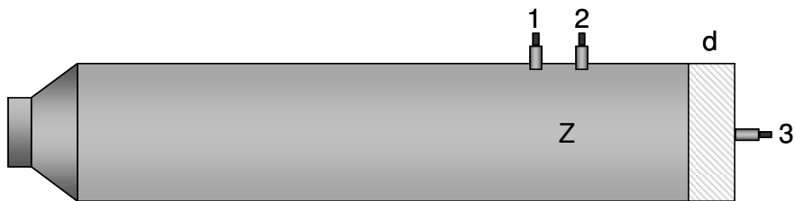
Figura 7-6: Schema del metodo di misura a 3 microfoni.
