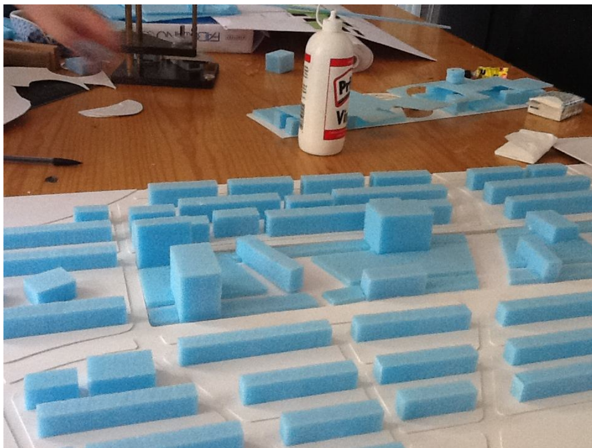
Illustrazione 3: La realizzazione di un modellino in blue foam
