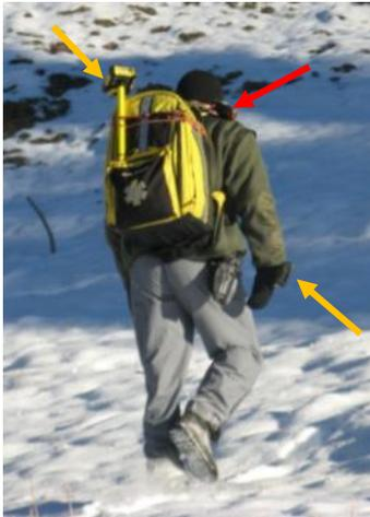
Figura 21: operatore in cammino con i GPS. La freccia rossa indica il GARMIN® 62cs e le frecce gialle da sinistra a destra indicano rispettivamente l'antenna e il palmare del PROXH TRIMBLE®
