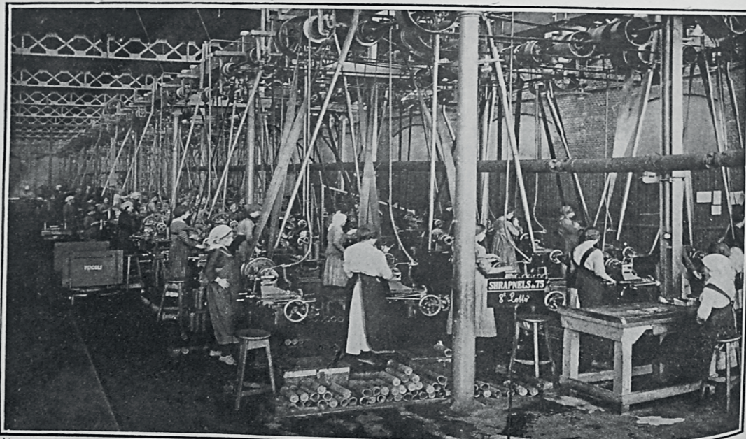
Veduta del riparto femminile della Torneria. - Lavorazione e controllo delle ogive per proiettili da 75 e 105 mm.
