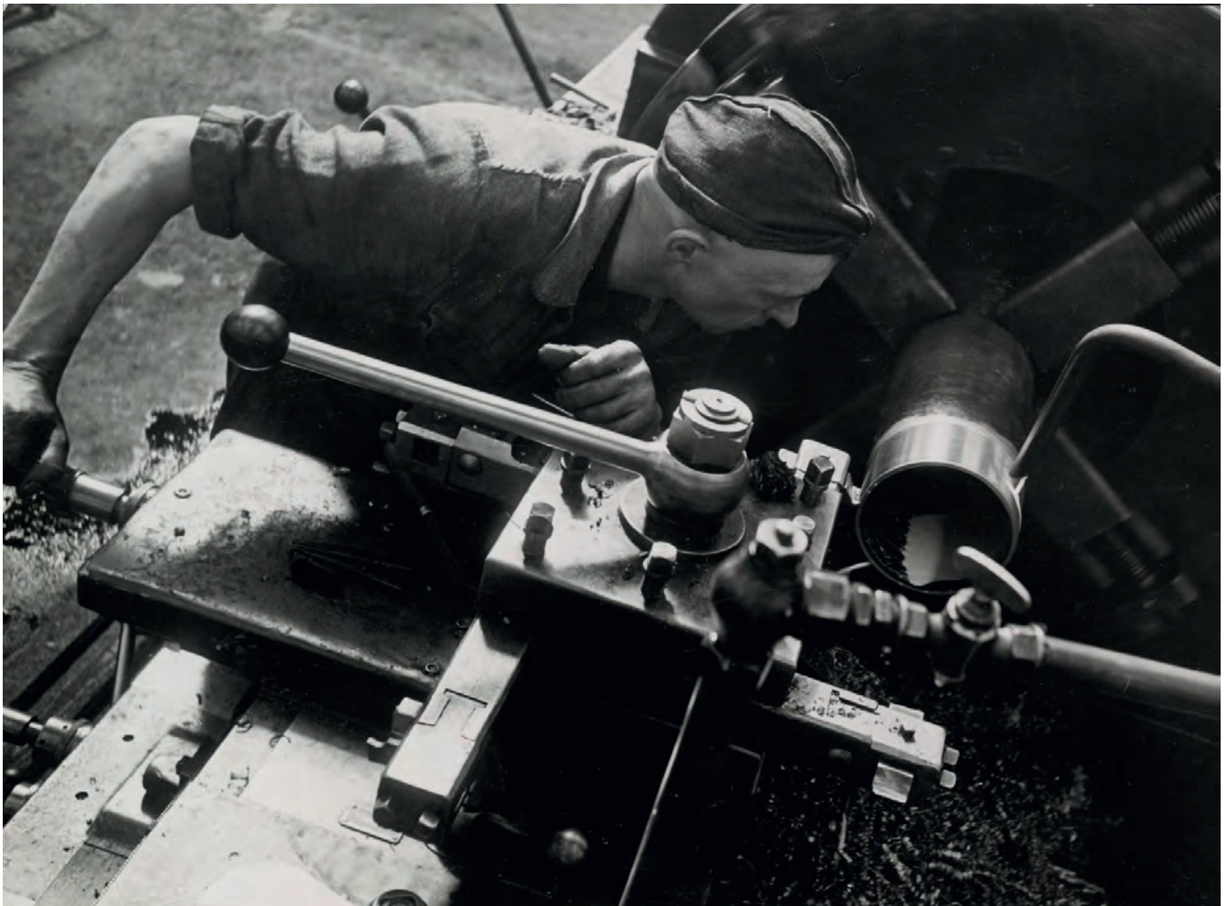
1.8 Bruno Stefani per Studio Boggeri, Dalmine, reparto tubi per trivellazione, filettatura , anni trenta. AFFD, DA_F_p00065_015, © Dalmine s.p.a. Archivio Fondazione Dalmine.
