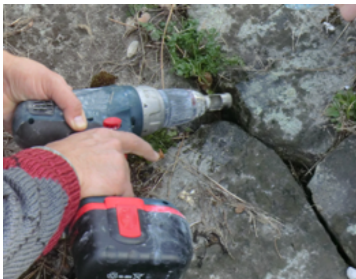
Fig. 37 – Aquileia (UD), porto fluviale. Campionamento di una delle rampe per la discesa alla Natissa (foto autore, marzo 2013).
