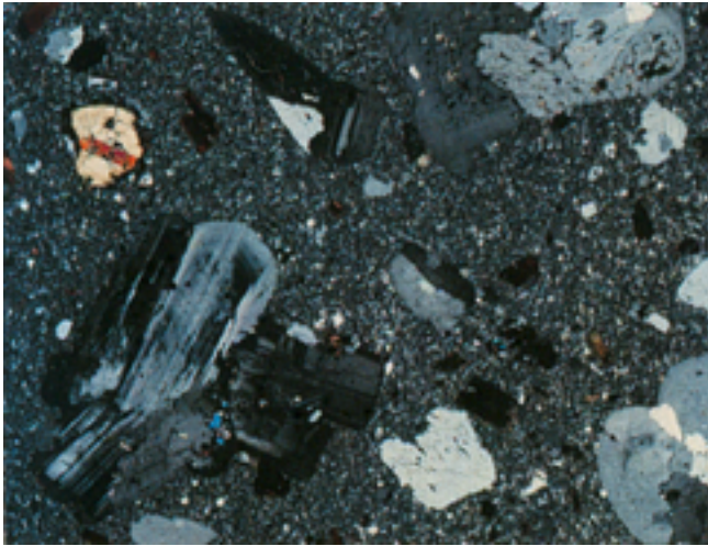
Fig. 16 – Trachite di Zovon, sezione sottile. Si osserva la struttura porfirica con prevalenza di fenocristalli di feldspato di potassio e massa di fondo microcristallina (ASTOLFI, COLOMBARA 2003 2 , fig. 41, p. 43).
