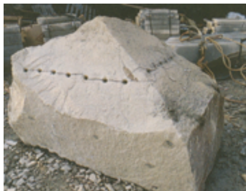
Fig. 51 – Blocco di trachite in fase di prima squadratura secondo il metodo della “spaccata” (ASTOLFI, COLOMBARA 2003 2 , p. 220, fig. 271).
