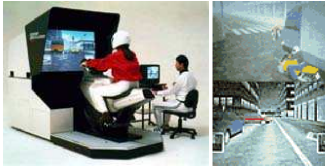
Figura 14 - Terzo prototipo di simulatore Honda (1993)
