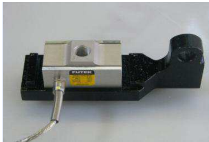
Figura 54 – Cella di carico Futek integrata nella pedana
