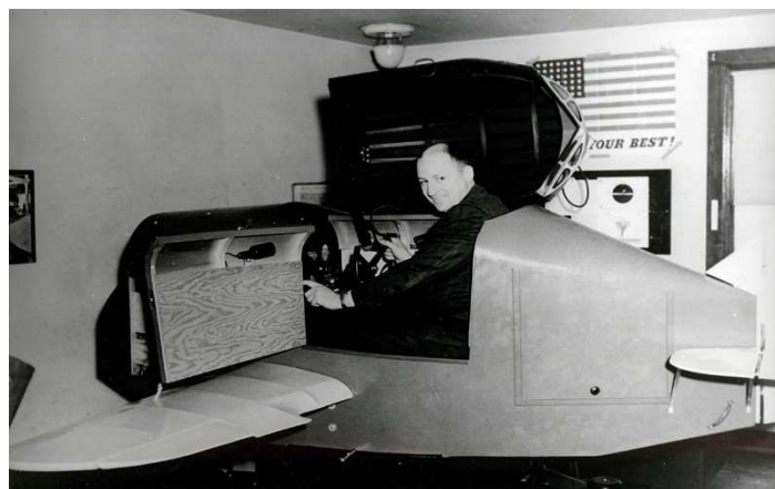
Figura 9 - primo simulatore di volo ad opera di Ed Link
