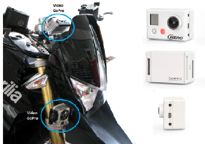
Figura 58 – Posizionamento delle due videocamere GoPro
