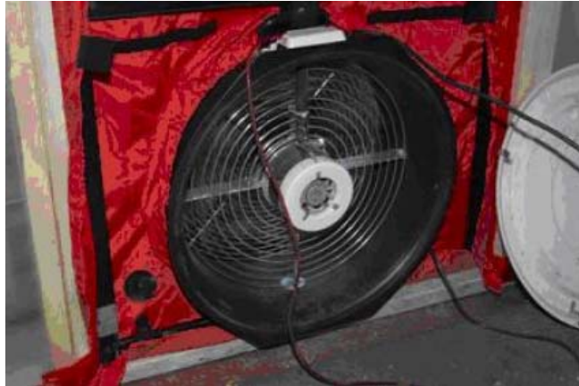
Figura 19. Blower Door Test. Ventilatore.
