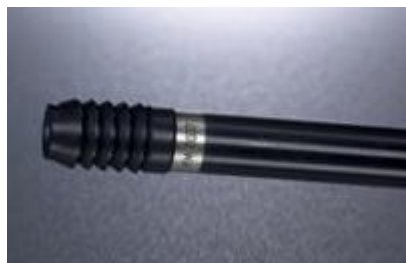
Figura 17. Igrometro per la misura dell'umidità relativa espressa come rapporto tra quantità di vapore acqueo contenuto in una massa d'aria e quantità massima di vapore acqueo che la stessa massa d'aria riesce a contenere (uguali condizioni di temperatura e pressione).
