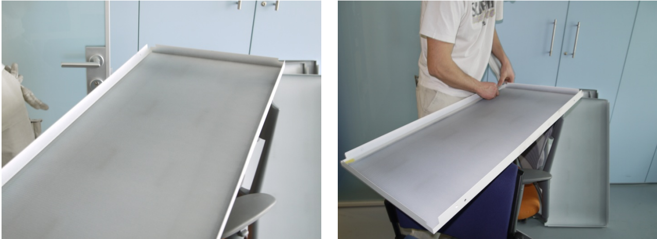
Figura 62. Pannello microforato senza guarnizione (a sinistra); pannello durante l'installazione della guarnizione (a destra).
