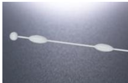
Figura 18. Anemometro omnidirezionale a sfera calda che, basandosi sul principio della differenza di temperatura, è sviluppato per rispondere rapidamente alle variazioni della velocità dell'aria (fluttuazioni) tipiche degli ambienti interni.
