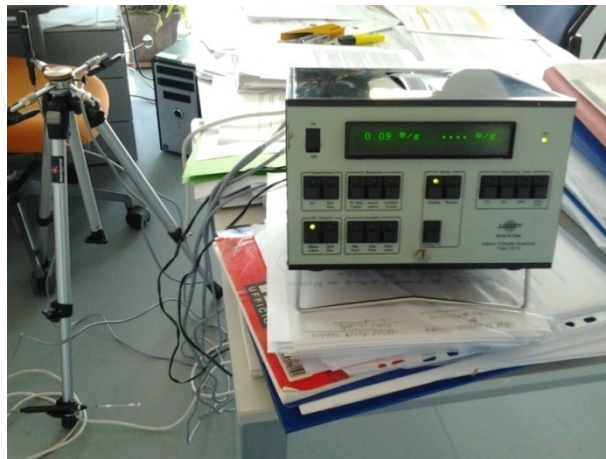
Figura 66. Centralina microclimatica Brüel & Kjær. Misura della velocità dell'aria a 0.1 m da terra.
