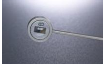
Figura 16. Sensore per la misura dell'asimmetria della temperatura radiante
