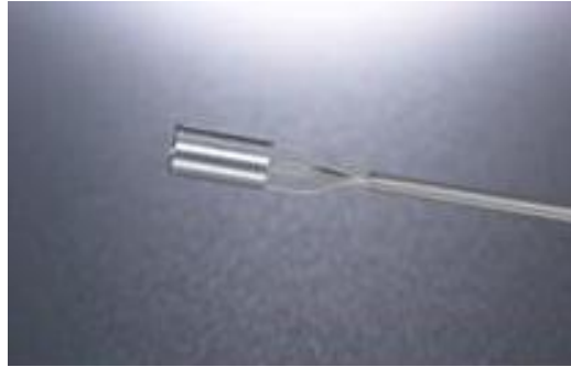
Figura 14. Trasduttore dotato di una resistenza al platino e di una schermatura contro la radiazione termica costituita da un cilindro lucido in alluminio, che lascia libero il flusso dell'aria attorno al sensore.
