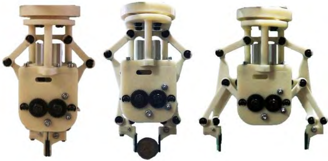
Figura 5.30: Alcune foto del prototipo di End-Effector realizzato, dove è possibile notare tre gradi di apertura della corsa di regolazione.
