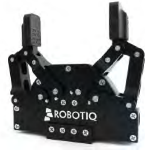
Figura 5.8: Un esempio di gripper elettrico, dotato di griffe adattabili, proposto dalla ROBOTIQ di St-Nicolas - Canada.
