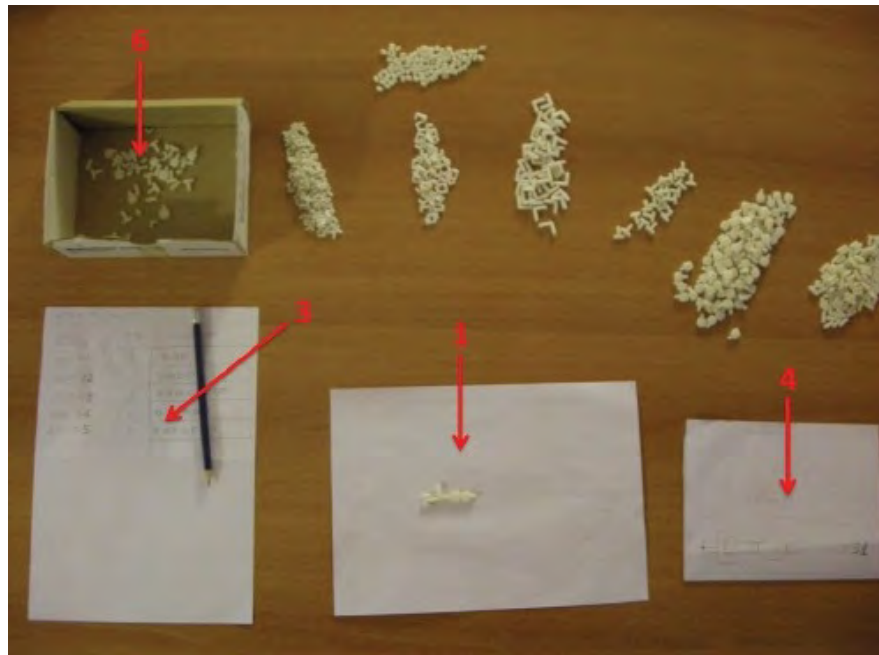
Figura 3.2: Disposizione sul tavolo del materiale usato per svolgere i test di assemblaggio manuale. La numerazione corrisponde alle operazioni preliminari elencate.
