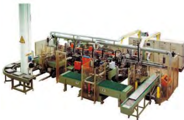
Figura 1.1: Macchina dedicata per l'assemblaggio di cassette. Per gentile concessione di T.S.R. costruzione macchine speciali s.r.l., Mestrino (PD) - Italia.
