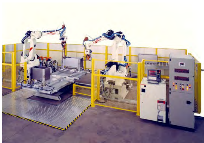
Figura 1.3: Cella robotizzata di assemblaggio per cassettiere. Per gentile concessione di T.S.R. costruzione macchine speciali s.r.l., Mestrino (PD) - Italia.
