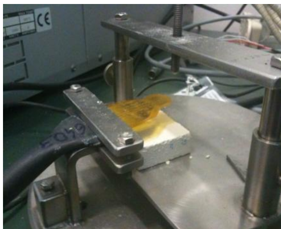
Figura 6.3 Sensore e provino alloggiati sul piano di appoggio del contenitore Hot disk.
