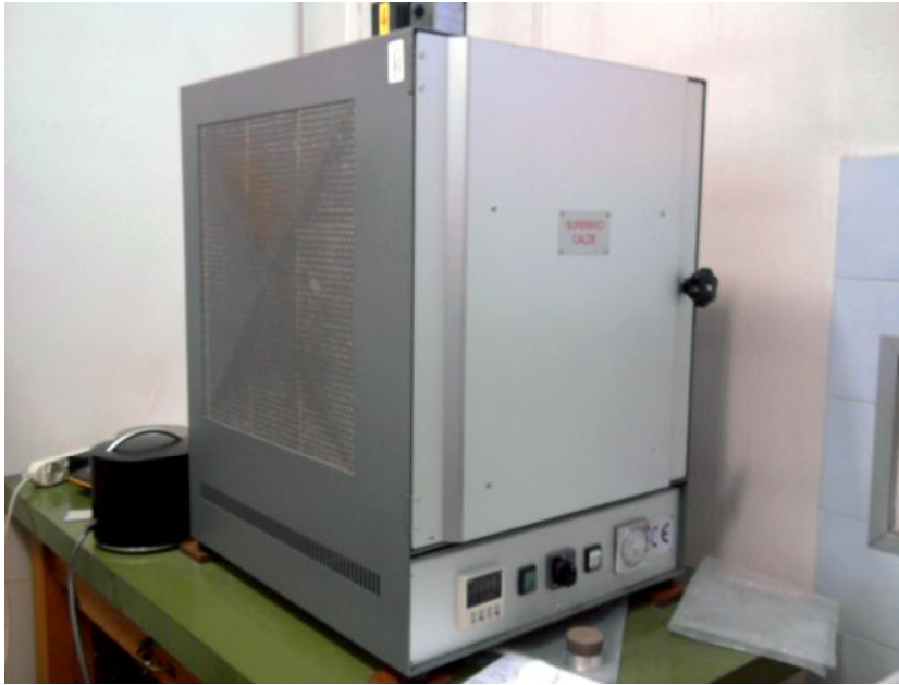
Figura 8.2 Forno per le alte temperature presente nel Laboratorio di Fisica Tecnica dell'Università degli Studi di Padova.
