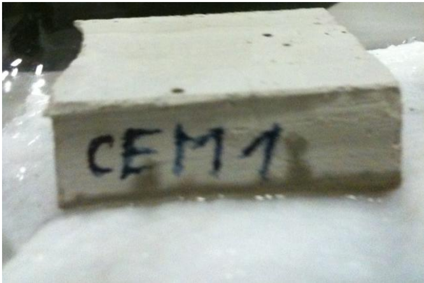
Figura 8.12 Provino PCM in fase di imbibizione.
