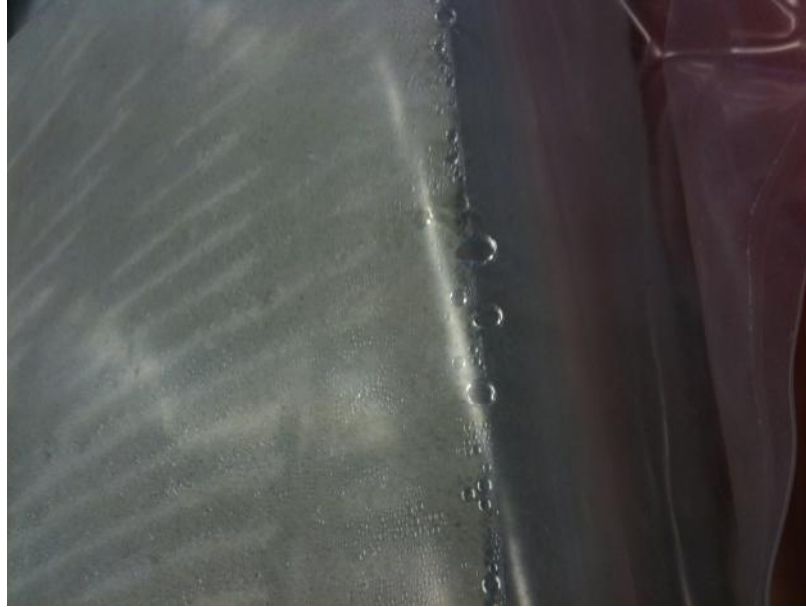
Figura 10.17: Umidità in fase liquida, al termine della prova, sulla busta contenente il provino provino.
