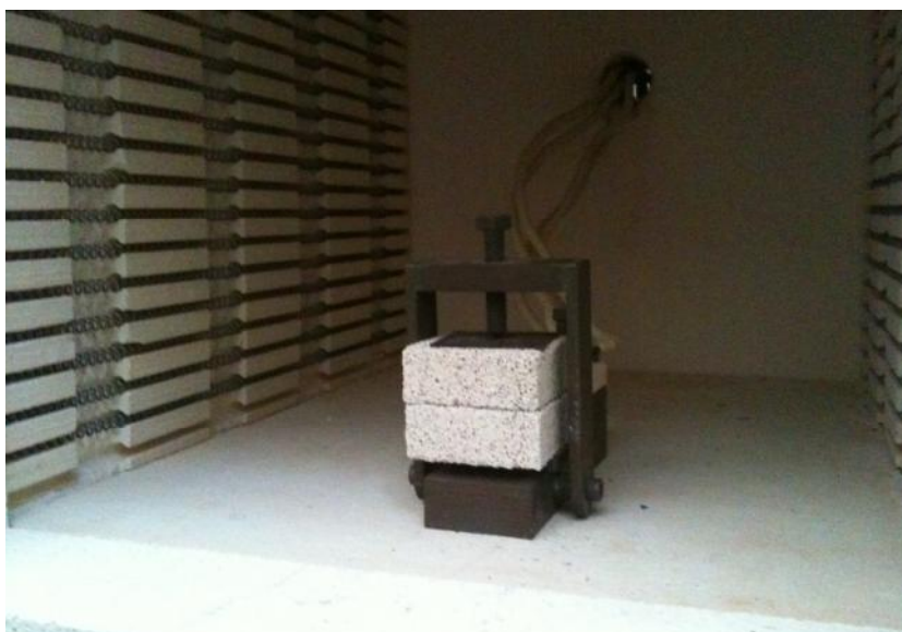
Figura 8.1 Provino di AAC nel forno per le alte temperature.
