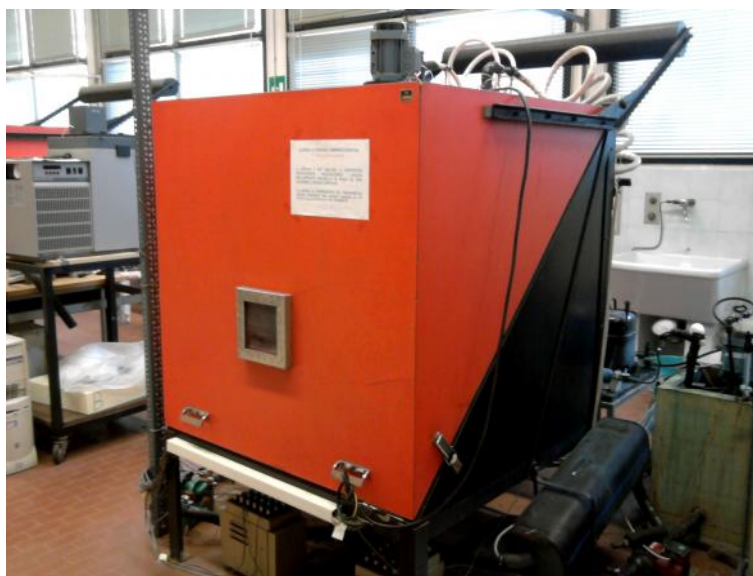
Figura 6.8 Apparecchiatura a termoflussimetri HFM presente nel Laboratorio di Fisica Tecnica dell'Università degli Studi di Padova.
