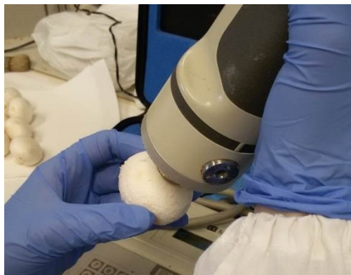
Figura 5.1. Misurazione del colore con colorimetro ottico Minolta CR-300, secondo il metodo Hunter Lab
