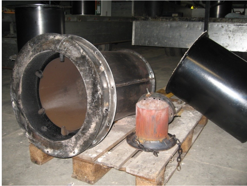
Figura 4-20 Elementi costituenti la prima versione del reattore di gassificazione
