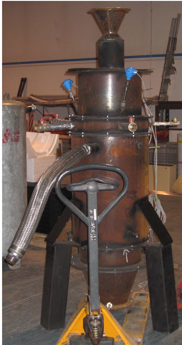
Figura 4-25 Versione finale del reattore di gassificazione
