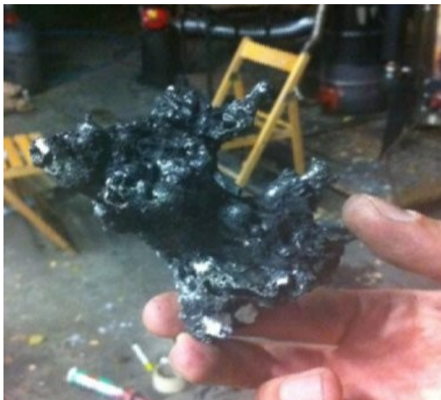
Figura 4-12 Agglomerati dovuti al contenuto di ceneri bassofondenti
