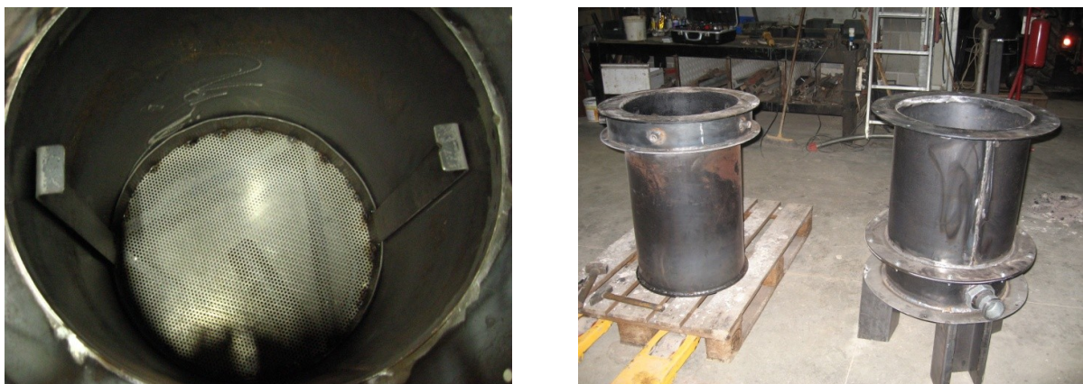
Figura 4-28 Griglia di fondo e struttura del biofiltro
