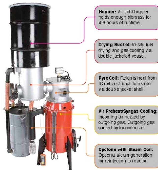
Figura 4-9 Componenti del sistema Tower Of Total Thermal Integration (TOTTI) (fonte: All Power Labs)
