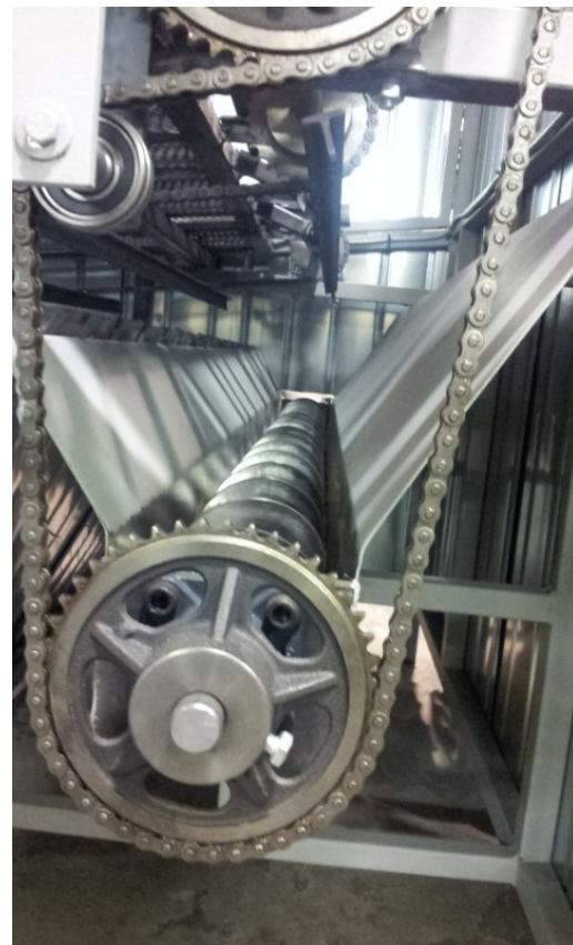
Figura 4-17 Particolare coclea di trasporto biomassa
