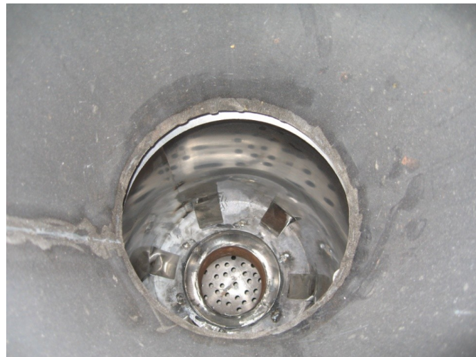
Figura 4-23 Griglia posta nel fondo del reattore
