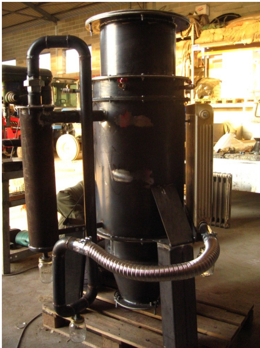
Figura 4-19 Prima versione del reattore di gassificazione
