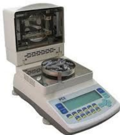
Figura 4-5 Bilancia per la misura dell'umidità relativa della biomassa
