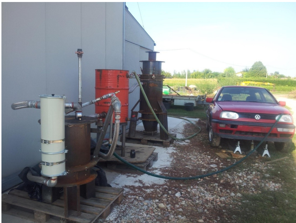
Figura 4-31 Test di valutazione della qualità del syngas ottenuto
