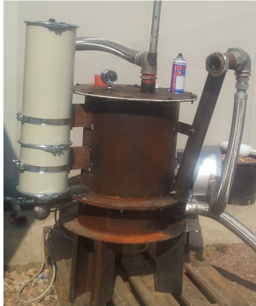
Figura 4-29 Primo sistema di filtrazione comprensivo di filtro a ciclone e biofiltro
