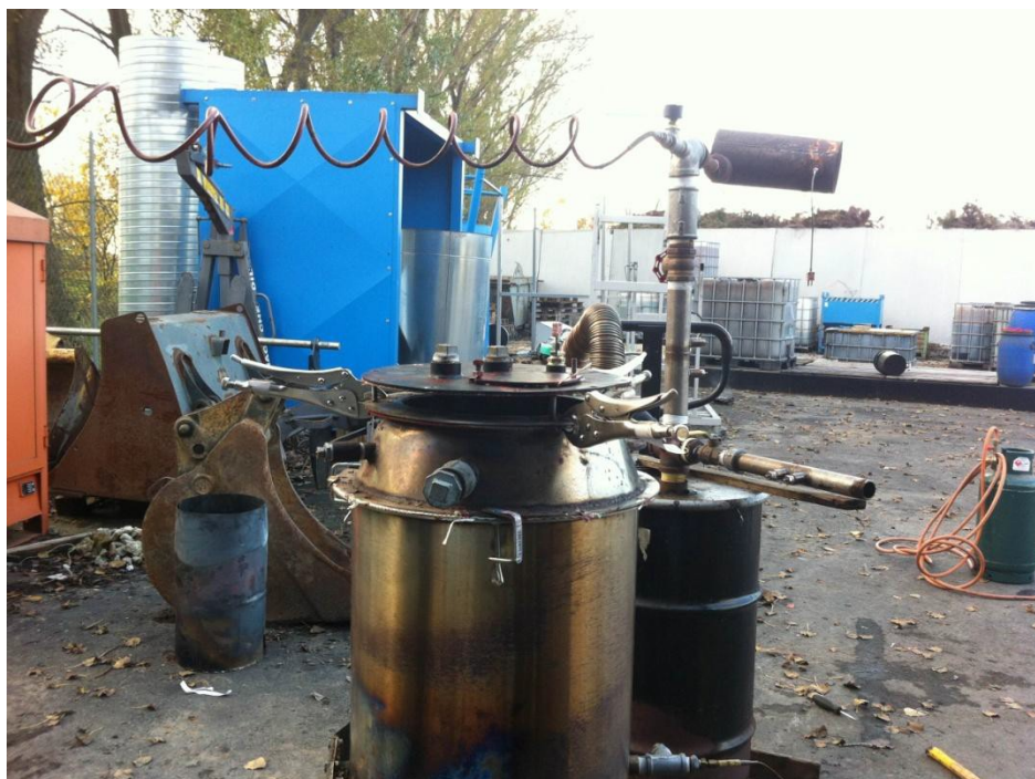
Figura 4-11 modifiche introdotte per rendere il gassificatore a letto fisso equicorrente stratificato (fonte: BEELAB)
