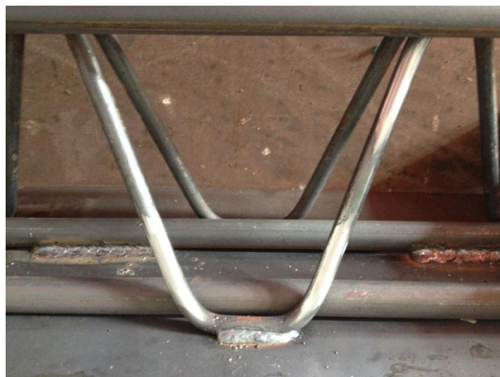
Figura 4.13 4.14 4.15: TRR Serie – Particolare saldature inferiori
