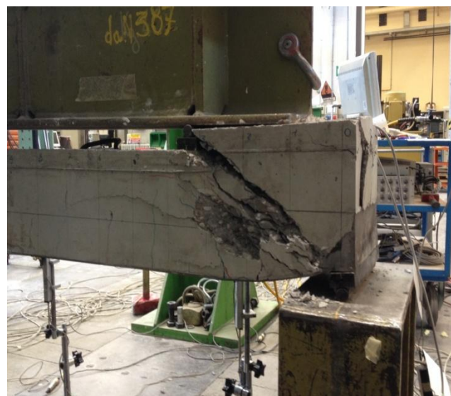
Figura 4.41 4.42: TRR Serie 2 a rottura
