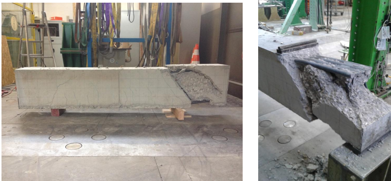
Figura 4.61e 4.62: Formazione biella calcestruzzo TRR Ponte
