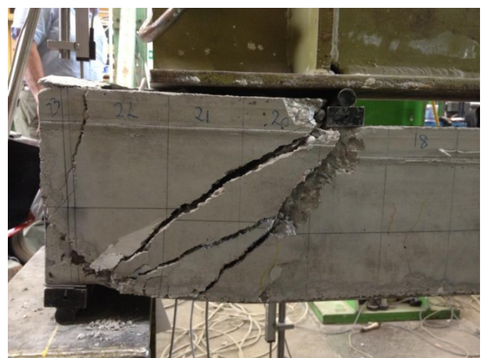
Figura 4.39 4.40: TRR Serie 1 a rottura
