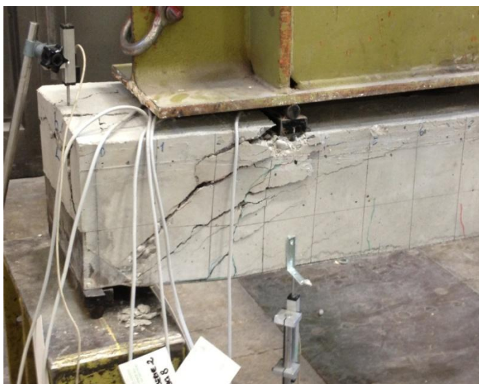
Figura 4.41 4.42: TRR Serie 2 a rottura
