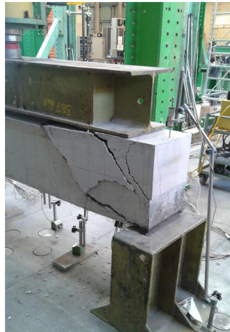
Figura 4.47 4.48: TRR Ponte 2 a rottura
