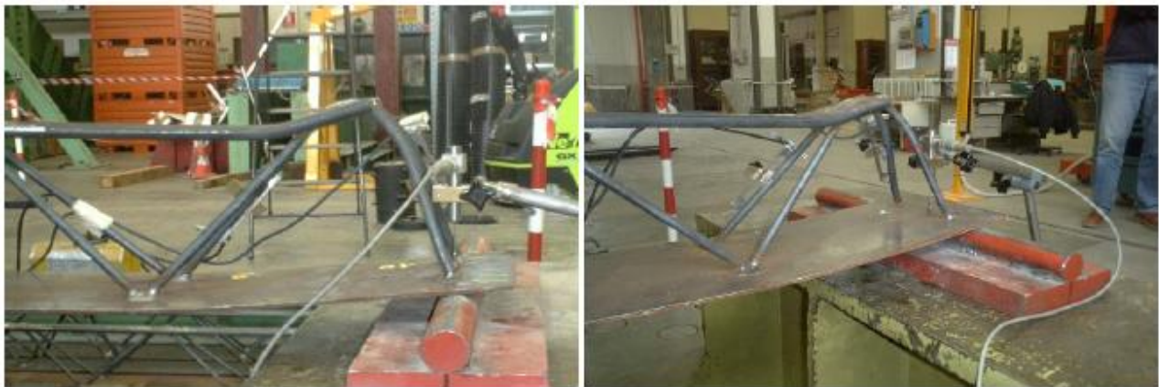
Figura 1.6: Prova a flessione sul traliccio in prima fase [03], [04]
