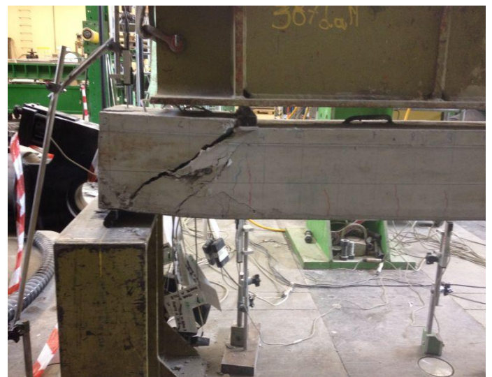
Figura 4.43 4.44: TRR Serie 3 a rottura
