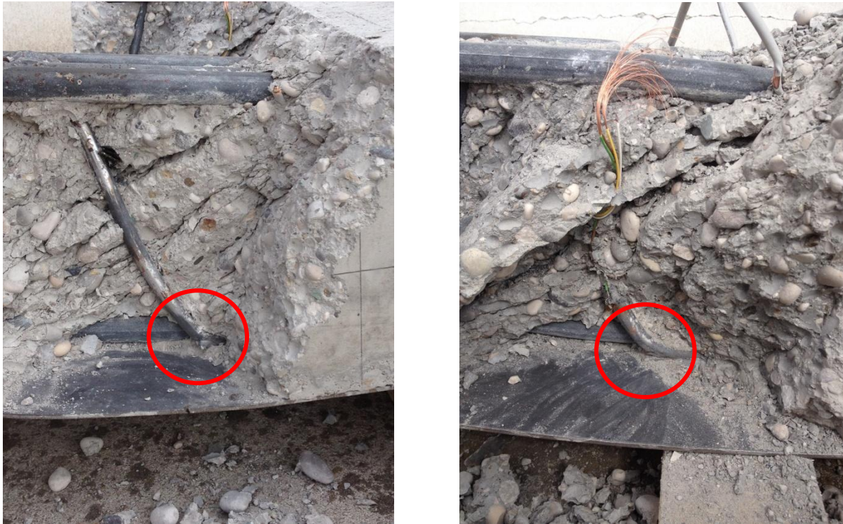
Figura 4.56 4.57: Rottura TRR Serie con strappo saldature
