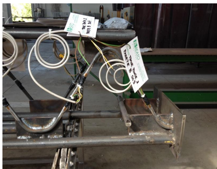
Figura 4.25 4.26 4.27: TRR Ponte – Applicazione strain gages
