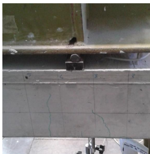
Figura 4.33 4.34: Dispositivi di appoggio
