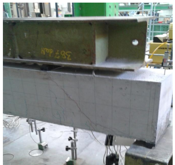
Figura 4.58: Quadro fessurativo TRR Ponte
