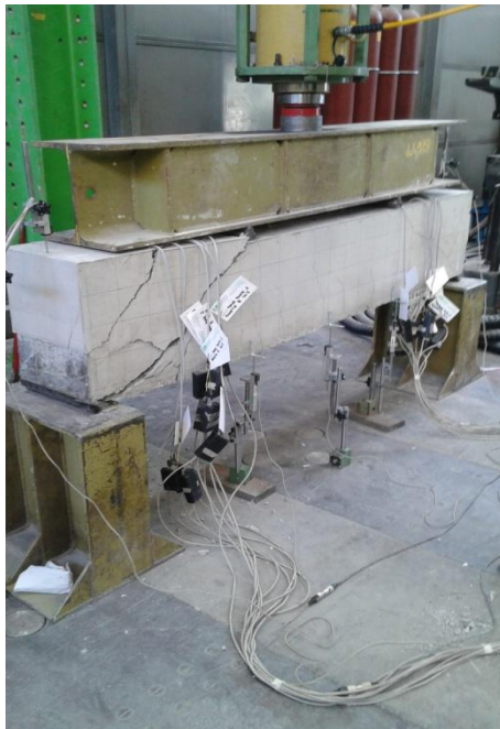
Figura 4.47 4.48: TRR Ponte 2 a rottura
