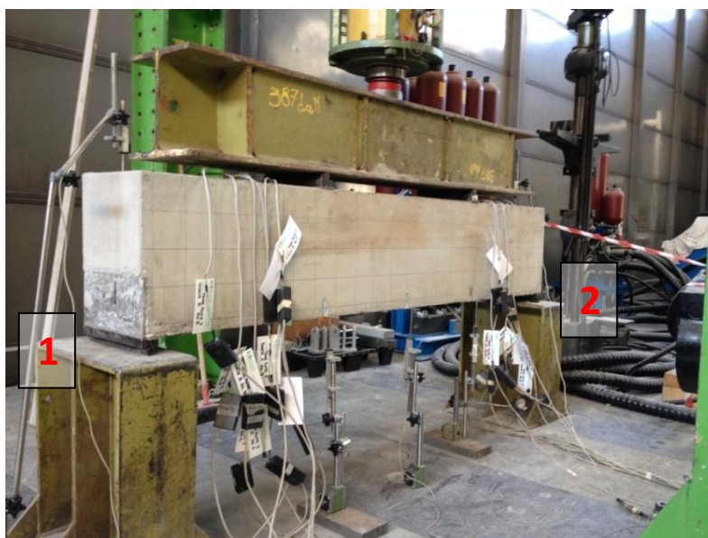
Figura 4.35 4.36: Allestimento prova laboratorio TRR Serie e TRR Ponte
