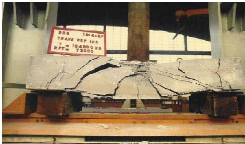
Figura 1.7: Rottura a taglio in una trave reticolare mista [05]
