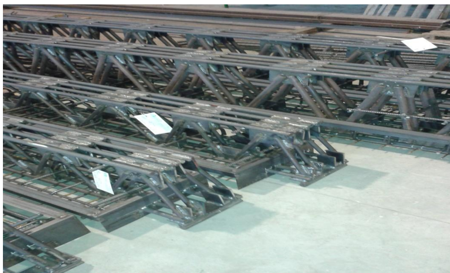
Figura 2.24 e 2.25: Travi TRR Ponte realizzate
