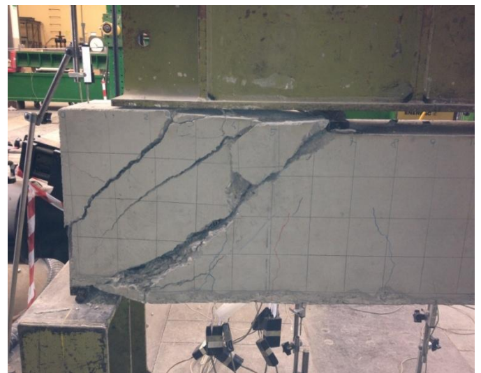
Figura 4.49 4.50: TRR Ponte 3 a rottura
