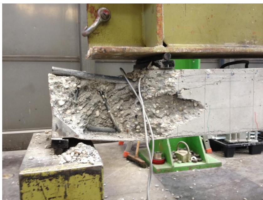
Figura 4.55: Rottura TRR Serie con schiacciamento calcestruzzo
