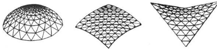
Figura 6.21: Gusci reticolari con diverse curvature (da Prete 1976)
