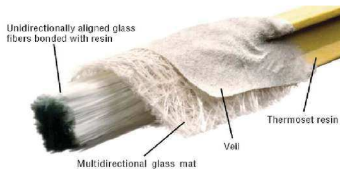
Figura 6.39: Struttura di un profilo pultruso in polimero fibrorinforzato (da [59])
