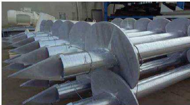
Figura 6.7: Pali prefabbricati ad elica in acciaio (da Geopal 2016)
