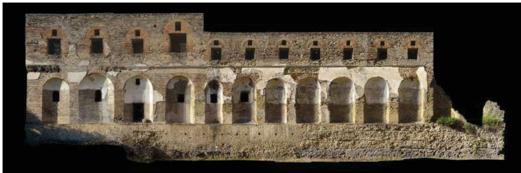
Figura 12.6: Restituzione fotogrammetrica della facciata del complesso vista da Sud (da [66])
