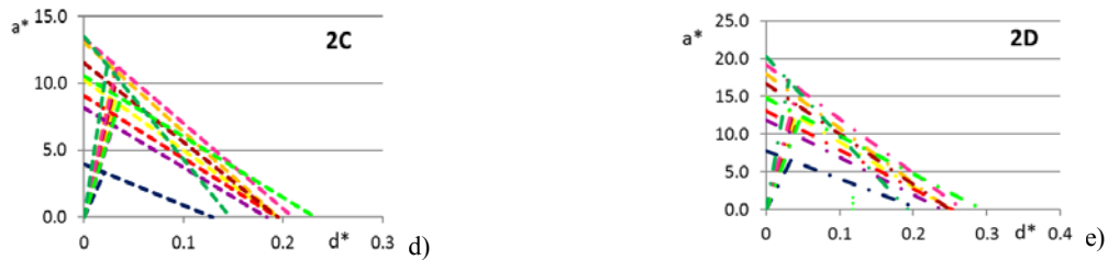
Figura 3 - 17: Curve di capacità relative al meccanismo di flessione verticale per la Tipologia 2 (a) e per le microtipologie (b) (c) (d) (e). A causa della grande variabilità dei risultati, non è stato possibile mantenere per i grafici gli stessi valori minimi e massimi degli assi
