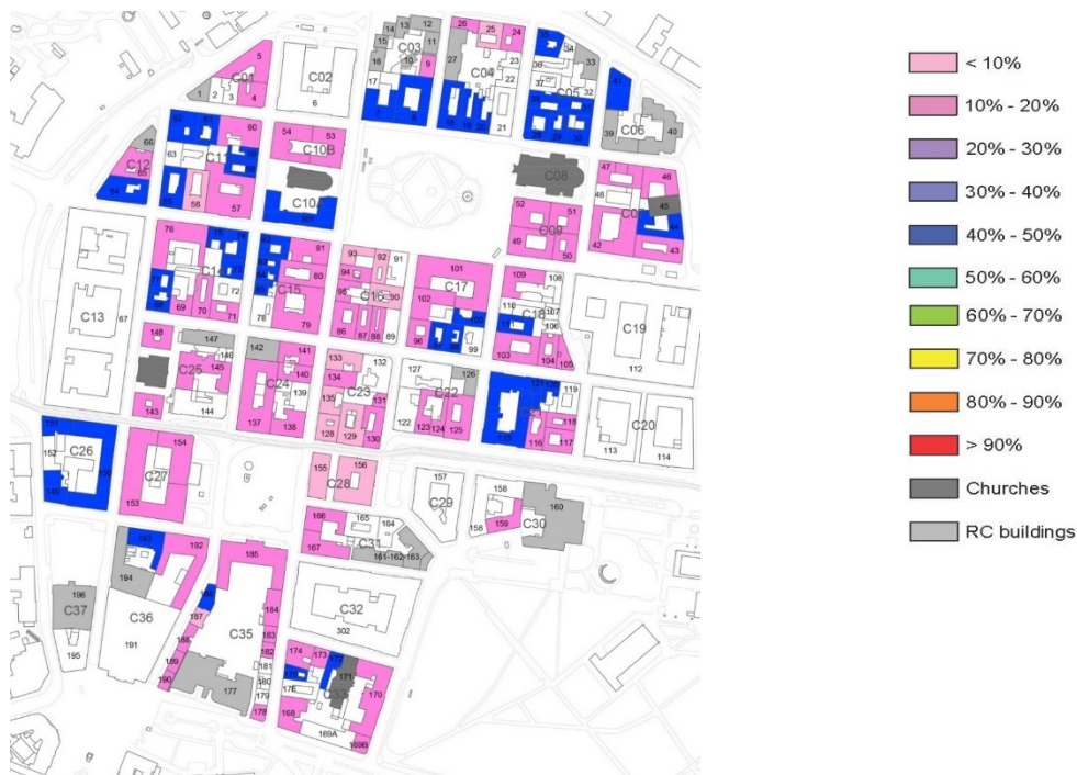
Figura 3 - 26: Mappa di vulnerabilità per il meccanismo di flessione verticale (livello di danno DL2, PGA=0.20g)
