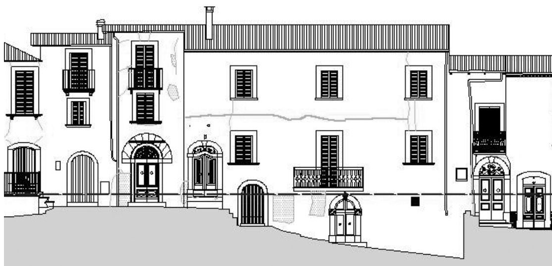
Figura 3 - 39: Quadro di danno di un edificio in aggregato sito presso Villa Santa Lucia degli Abruzzi
