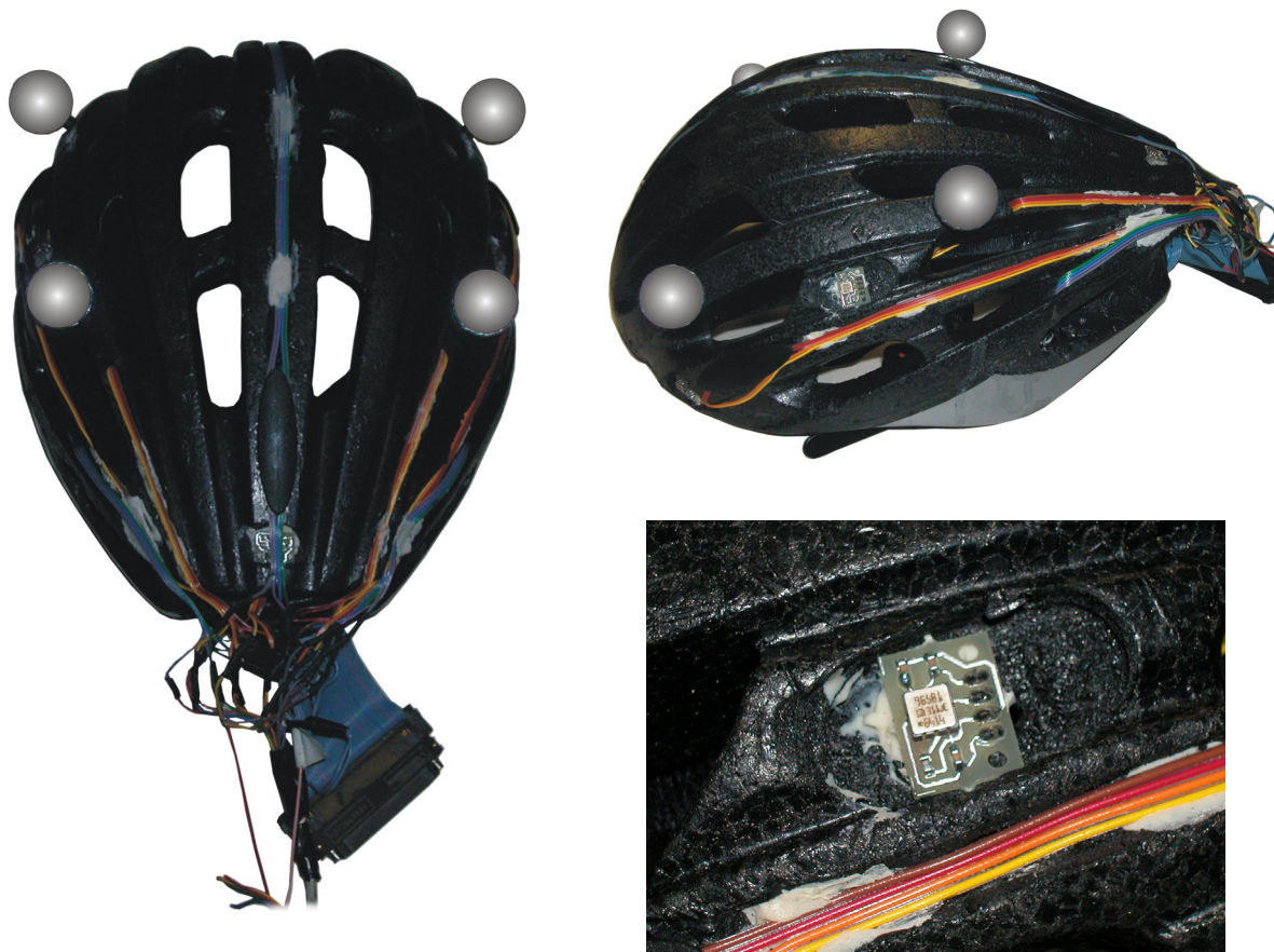
Figura 2.3 Casco strumentato con otto accelerometri biassiali
