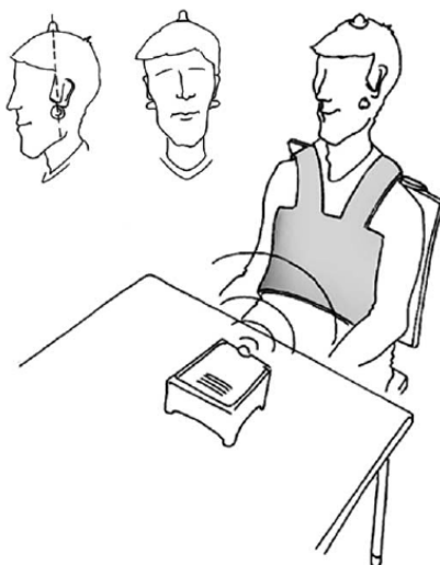
Figura 1.5 Set-up sperimentale composto da un trasmettitore di campo magnetico e tre ricevitori posti sulla testa del soggetto
