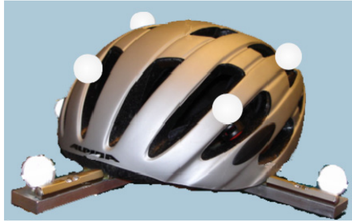
Figura 3.6 marker posizionati sul casco e su un crocetta di alluminio utile per individuare il sistema di riferimento solidale al casco
