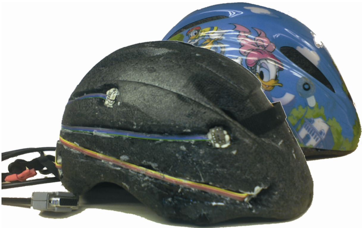
Figura 2. 5 Casco strumentato con dieci accelerometri lineari
