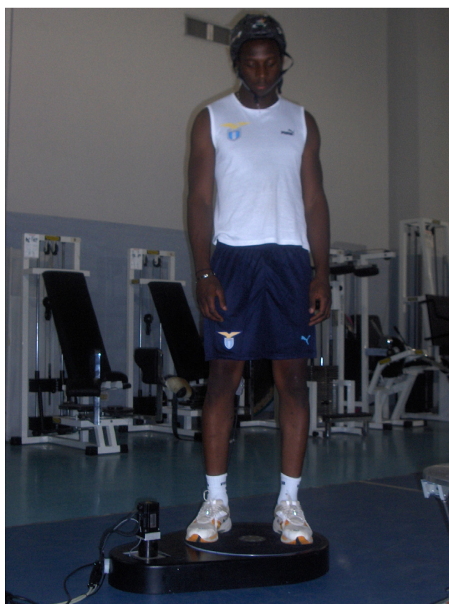
Figura 4.28 Soggetto sulla piattaforma 1 DOF con indosso il casco
