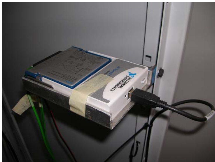
Figura 5.8. Sistema portatile di acquisizione NI USB-9211A per la lettura delle temperature del liquido di raffreddamento e dell'olio del motore.
