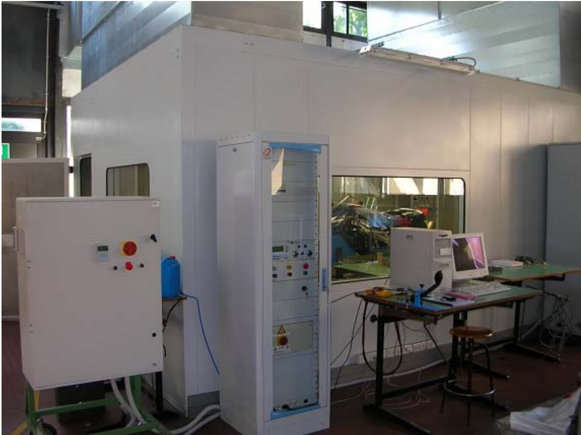
Figura 5.2. Sala di prova per motori a combustione interna presente nel Laboratorio di Macchine Termiche dell'Università degli Studi di Padova.
