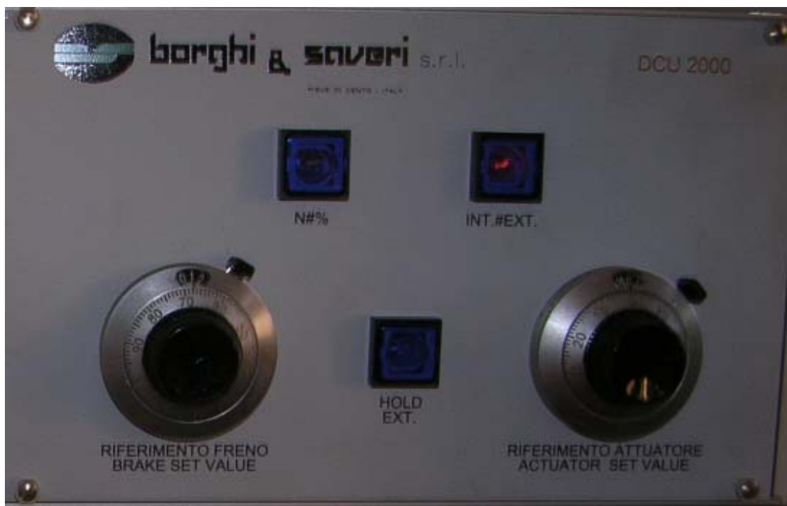
Figura 6.3. Particolare della centralina DCU 2000. Interruttori e potenziometro rotativo di regolazione del numero di giri al freno.
