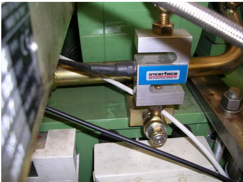
Figura 5.6. Particolare della cella di carico Interface, fissata tra basamento del freno e statore, per la misura della coppia.
