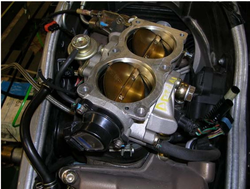
Figura 5.20. Particolare del corpo farfallato della motocicletta. Si notano le due valvole a farfalla, il potenziometro rotativo e in alto a sinistra il cavo di regolazione del grado di apertura delle valvole a farfalla.
