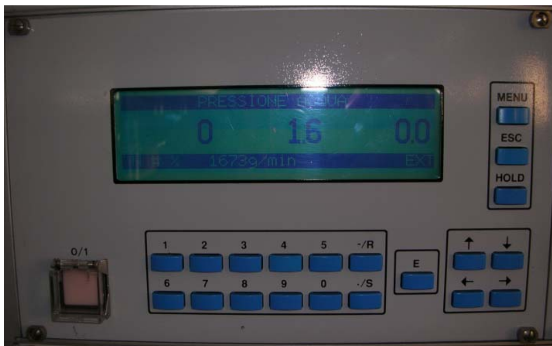
Figura 6.2. Il display della centralina Borghi & Saveri DCU 2000. Si notino il segnale d'errore "pressione acqua", il relativo valore di coppia misurata e il numero di giri impostati al freno.
