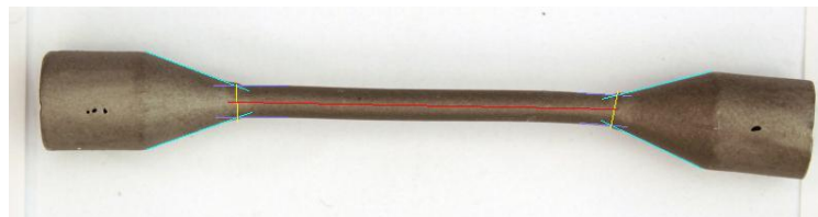
FIGURA 3.14 LUNGHEZZA DELLA PARTE CALIBRATA
