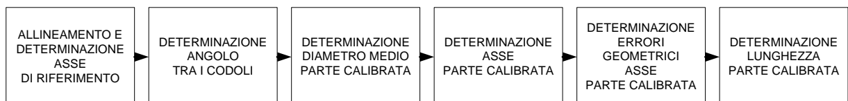
FIGURA 3.8 METODO UTILIZZATO PER LA CARATTERIZZAZIONE GEOMETRICA DEL PROVINO
