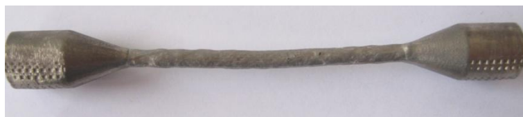
FIGURA 3.19 ESEMPIO DI PROVINO NON PORTATO A ROTTURA: L'INTERRUZIONE DELLA PROVA È AVVENUTA È PER IL SUPERAMENTO DEI LIMITI IMPOSTI
