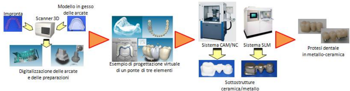
FIGURA 1.3 FASI DEL PROCESSO CAD/CAM PER LA REALIZZAZIONE DI PROTESI IN METALLO-CERAMICA
