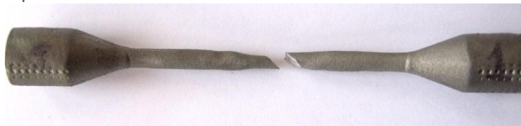
FIGURA 3.18 ESEMPIO DI UN PROVINO PORTATO A ROTTURA
