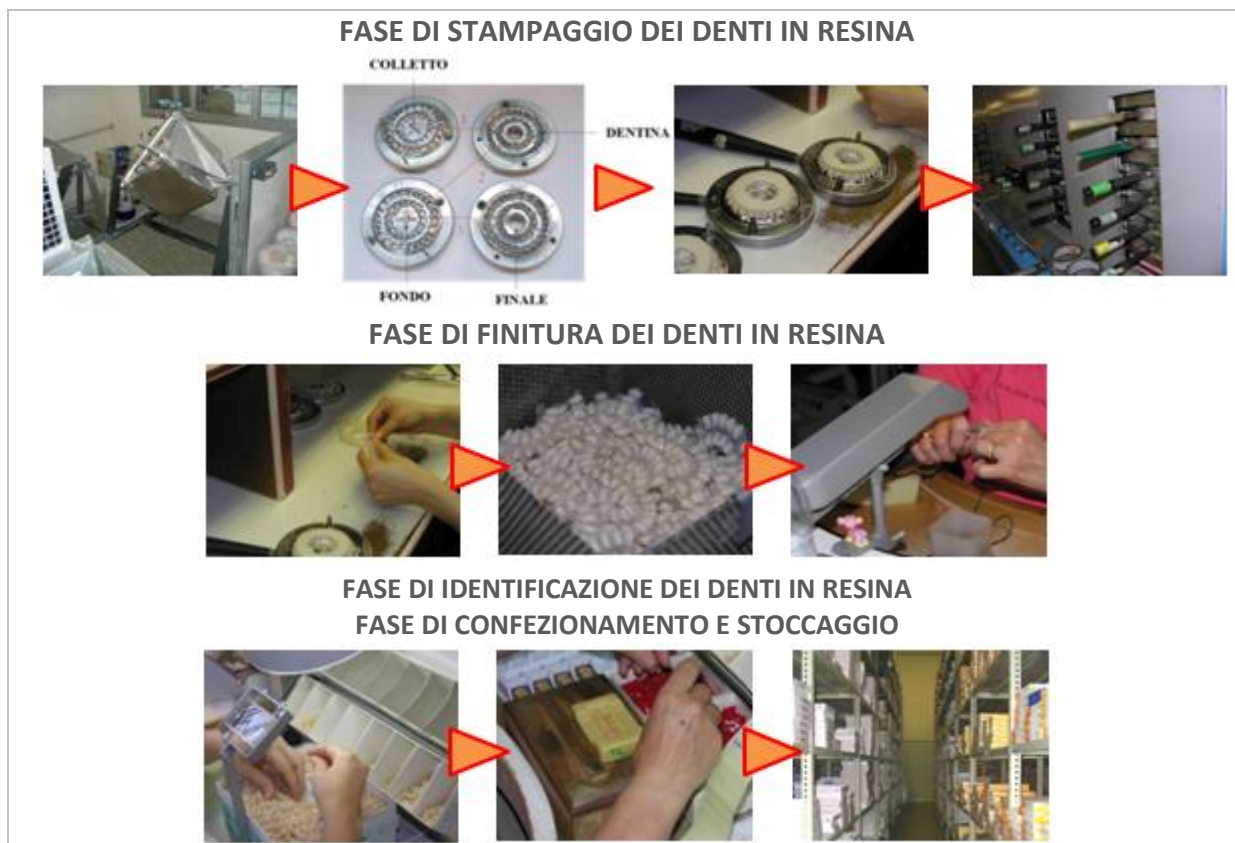
FIGURA 1.4 FASI DEL PROCESSO DI FABBRICAZIONE DI DENTI IN RESINA
