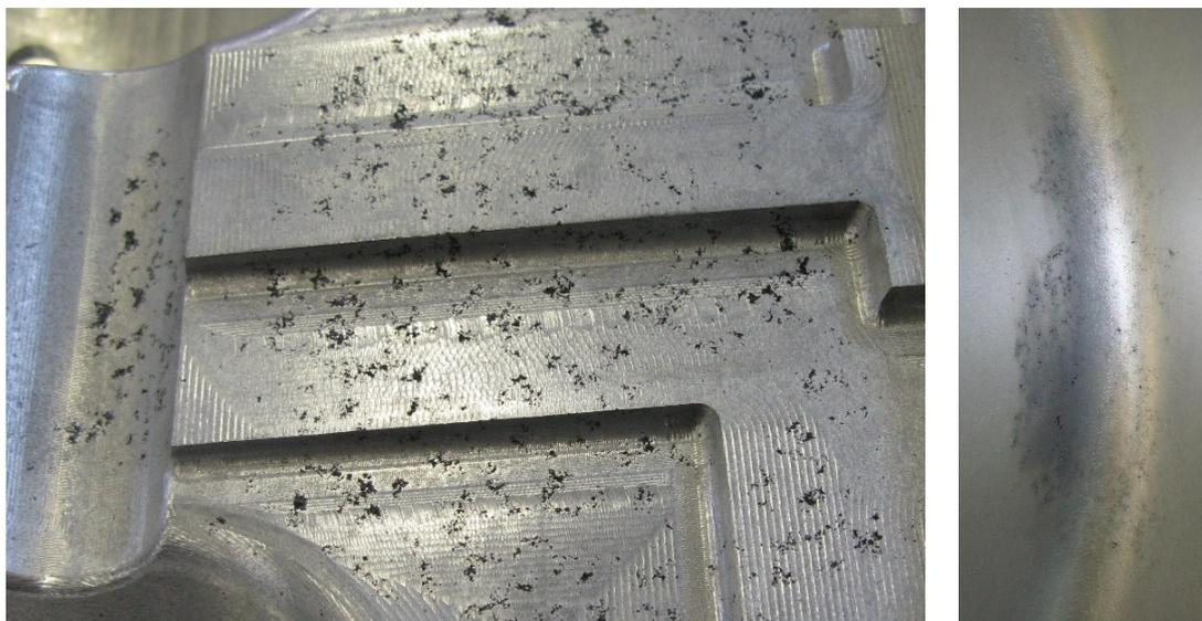
**(a)** Spesso per evidenziare questo tipo di difetti è necessario sabbiare o lavorare per asportazione di truciolo, poichè la pelle integra resiste alla pressione atmosferica comprendo il vuoto senza deformarsi. B311 secondo NDCA
