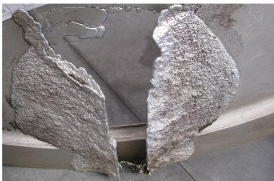
**(a)** Rottura della forma superiore: il liquido è penetrato nella cricca della sabbia sollevando i frammenti al di sopra, per una pressione di serraggio eccessiva su alcuni elementi di supporto interni alla forma di sabbia. Il difetto è classificabile con A221
