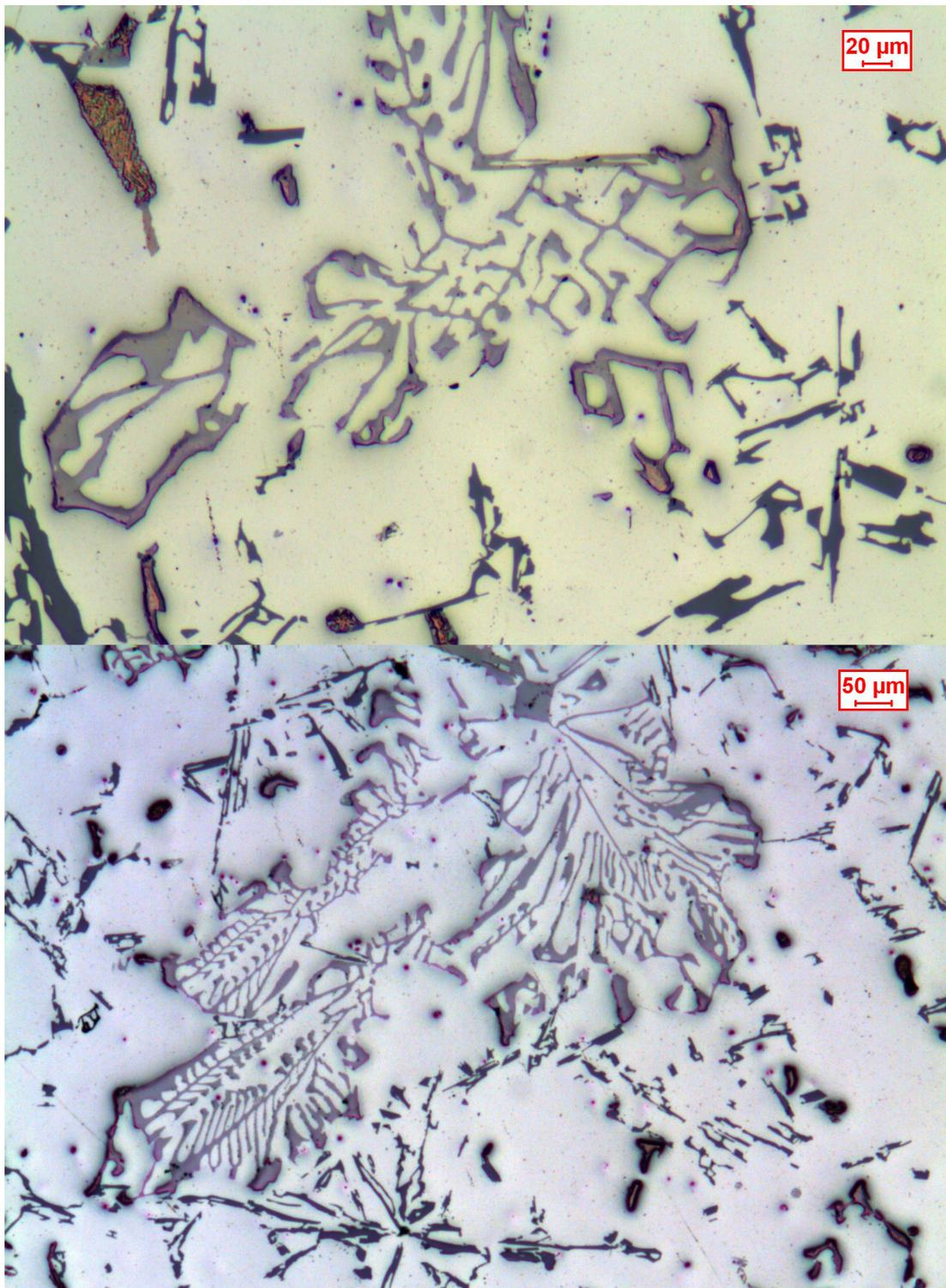
**Figura 1.5** – Altri esempi di microstrutture. Si può notare la precipitazione del rame e, nella foto inferiore, la complessità della forma dei precipitati Fe-Cr-Mn a ideogramma cinese.
