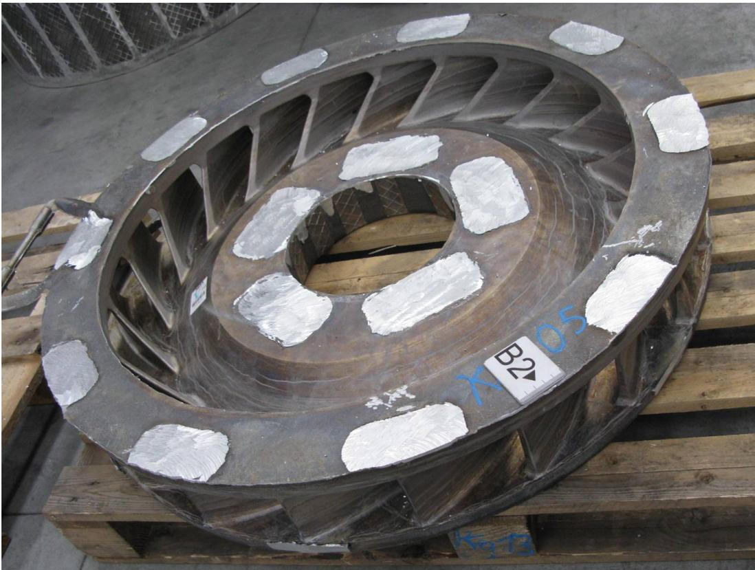
**Figura 3.2** – Il getto sul quale sono stati calcolati i tempi di riempimento teorici e misurati i tempi di colata reali è del tipo rotazionale per il settore energetico.
