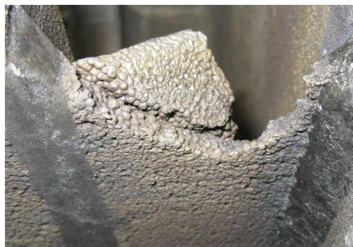
**(b)** Rottura del modello lost foam a causa della pressione della sabbia in formatura. Questo difetto non è classificabile secondo Nadca, in quanto la sua classificazione è più adatta alla colata in conchiglia
