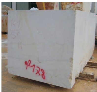
Figura 2.8: Uno dei blocchi destinati al taglio in lastre, quindi giudicato privo di discontinuità, utilizzato per le prove in cantiere.
