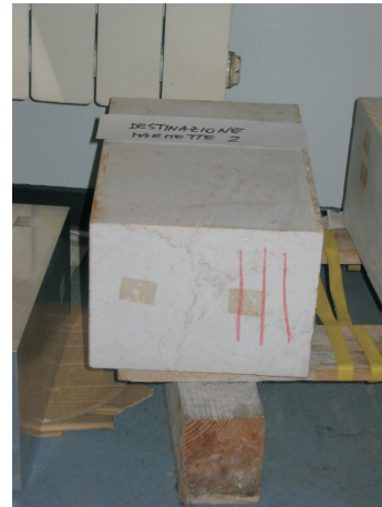
Figura 4.4: Uno dei blocchi di marmo da laboratorio con discontinuità evidente. Quest'ultima affiora sulla superficie frontale, da cui viene sollecitato il blocco.
