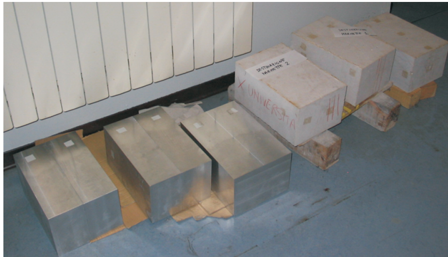
Figura 2.7: Blocchi, di marmo e di alluminio, utilizzati per le prove sperimentali in laboratorio. Di questi, uno di marmo e uno di alluminio sono integri, mentre gli altri presentano, per natura (quelli di marmo) o per costruzione (quelli di alluminio) discontinuità evidenti.
