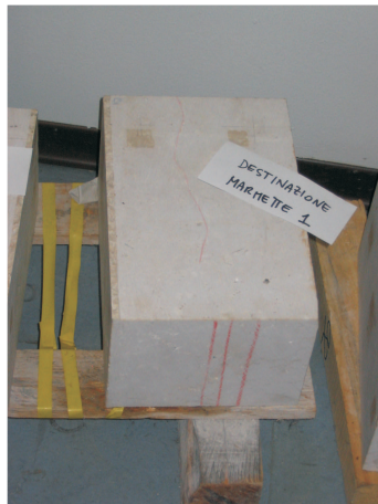
Figura 4.3: Uno dei blocchi di marmo da laboratorio con discontinuità evidente. Si può notare quest'ultima che affiora sulla faccia superiore.
