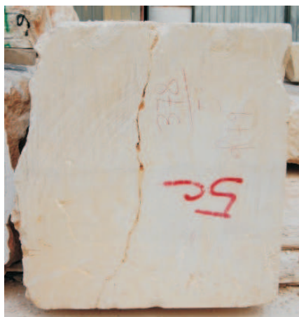
Figura 4.84: Fotografia del blocco 149-5C destinato alla lavorazione in marmette, su cui si è svolta una sessione di prove sperimentali.
