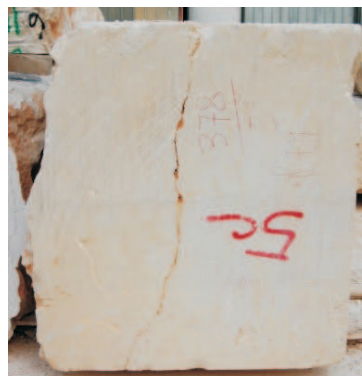
Figura 2.9: Uno dei blocchi destinati al taglio in marmette, quindi con discontinuità evidenti, utilizzato in cantiere per le prove sperimentali.
