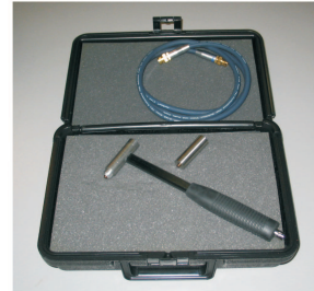
Figura 2.5: Martello strumentato utilizzato durante le prove in laboratorio su blocchi sia di marmo, sia di alluminio.
