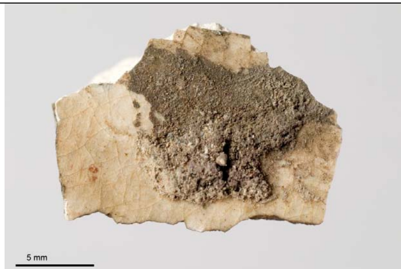
Fig.4.1.5.2: frammento di piastrella facente parte di una lesena bianca, sulla cui superficie si è depositata e solidificata un'incrostazione di colore grigio – nero.
