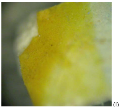
Fig.6.2.2.7: campione con stesura pittorica di colore giallo (I); microfotografia al microscopio ottico con ingrandimento a 500x di un campione allestito in sezione lucida corrispondente alla stesura di colore giallo scuro (II).
