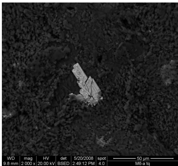
Fig. 7.1.4: cristalli di neoformazione con morfologia aciculare presenti nei pori delle malte (I); lo spettro EDS raccolto da uno di questi micro-cristalli indica che sono costituiti da silicio, piombo e vanadio (II). Cristalli di neoformazione di forma tabulare (III); spettro EDS che indica la presenza di cromo e di piombo (IV).
