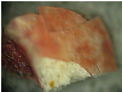
Fig.6.2.2.9: fotografia di un campione di colore rosso (I); microfotografia al microscopio elettronico a scansione di una stesura di colore rosso (1500x) dove (• a) indica il corpo ceramico, (• b) la stesura pittorica e (• c) la vetrina, costituita da ossido di stagno ed ematite (II).
