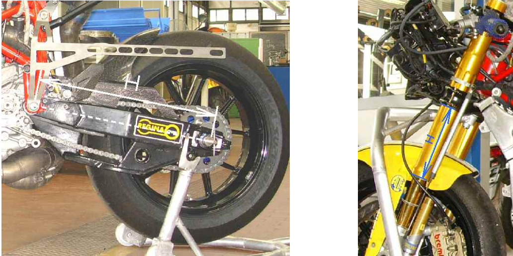
Figura 5-17 : Regolazione lunghezza forcellone ed altezza forcella
