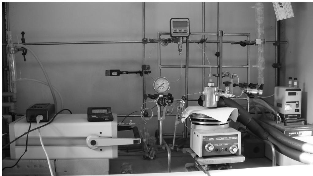
Figura 5.23: Apparato sperimentale utilizzato per la reazione di sintesi diretta di H<sub>2</sub>O<sub>2</sub> dopo l'inserimento del microGC (vedi testo)
