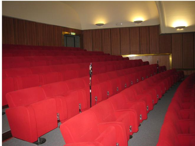
Figura 3.4: Posizionamento dei microfoni in sala
