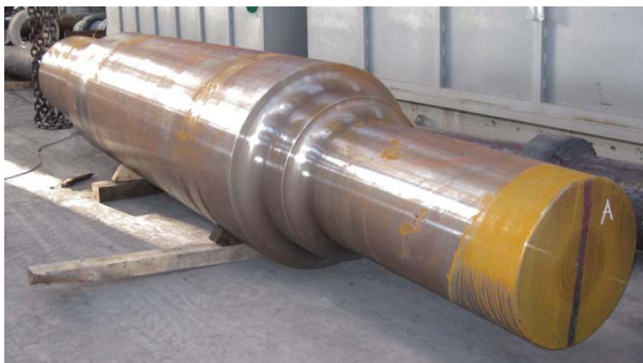
Figura 4.2: l'abero fucinato e presgrossato in attesa di subire il trattamento termico
