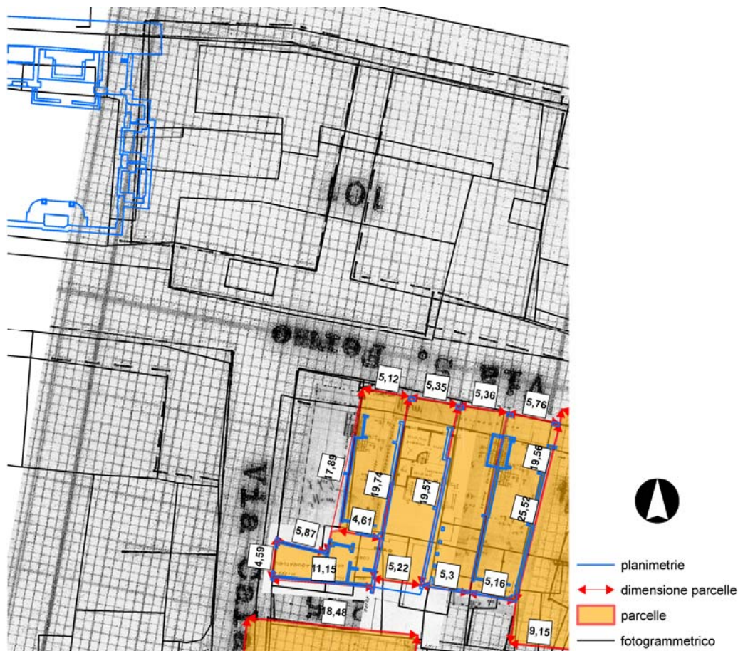
Figura 40: georeferenziazione delle planimetrie catastali e mappatura dei rilievi dei fabbricati, delle parcelle e delle relative dimensioni.
