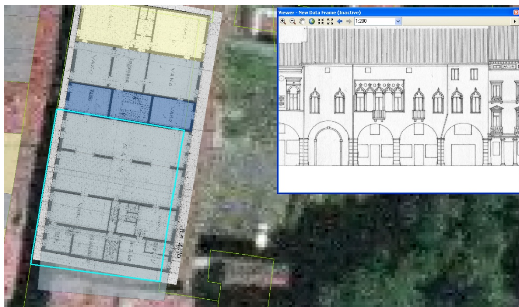
Figura 71: schermata dell'area di lavoro GIS. Nell'immagine la planimetrie catastale e il piano verticale con il prospetto.
