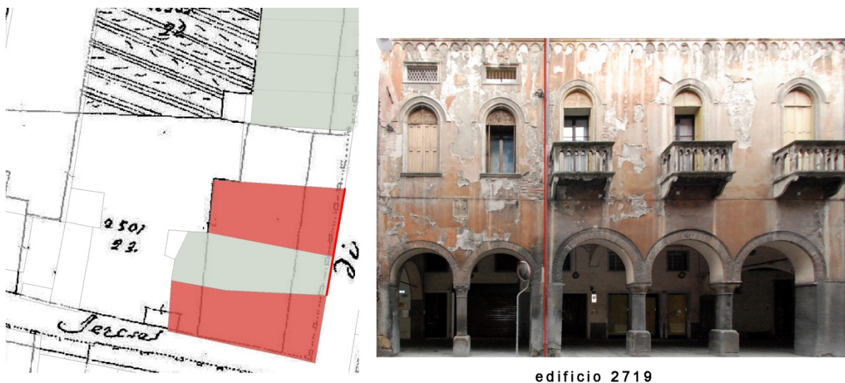
Figura 67: parcelle del gruppo 2. Planimetria e prospetto dell'edificio 2719 con sovrapposizione del catasto napoleonico.
