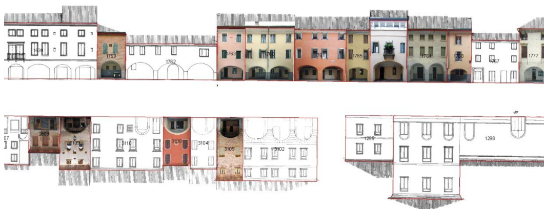
Figura 20: piano del GIS verticale con il posizionamento dei fotopiani e dei rilievi di Gaetano Croce.
