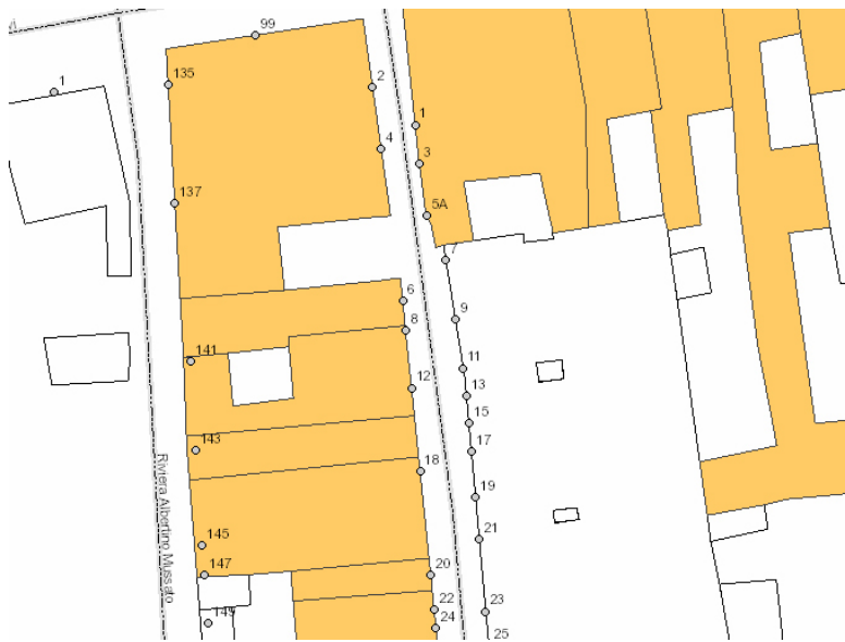
Figura 44: particolare del web GIS ARMEP. Nell'immagine sono evidenziati i layers che si attivano al superamento di una scala di visualizzazione stabilita.
