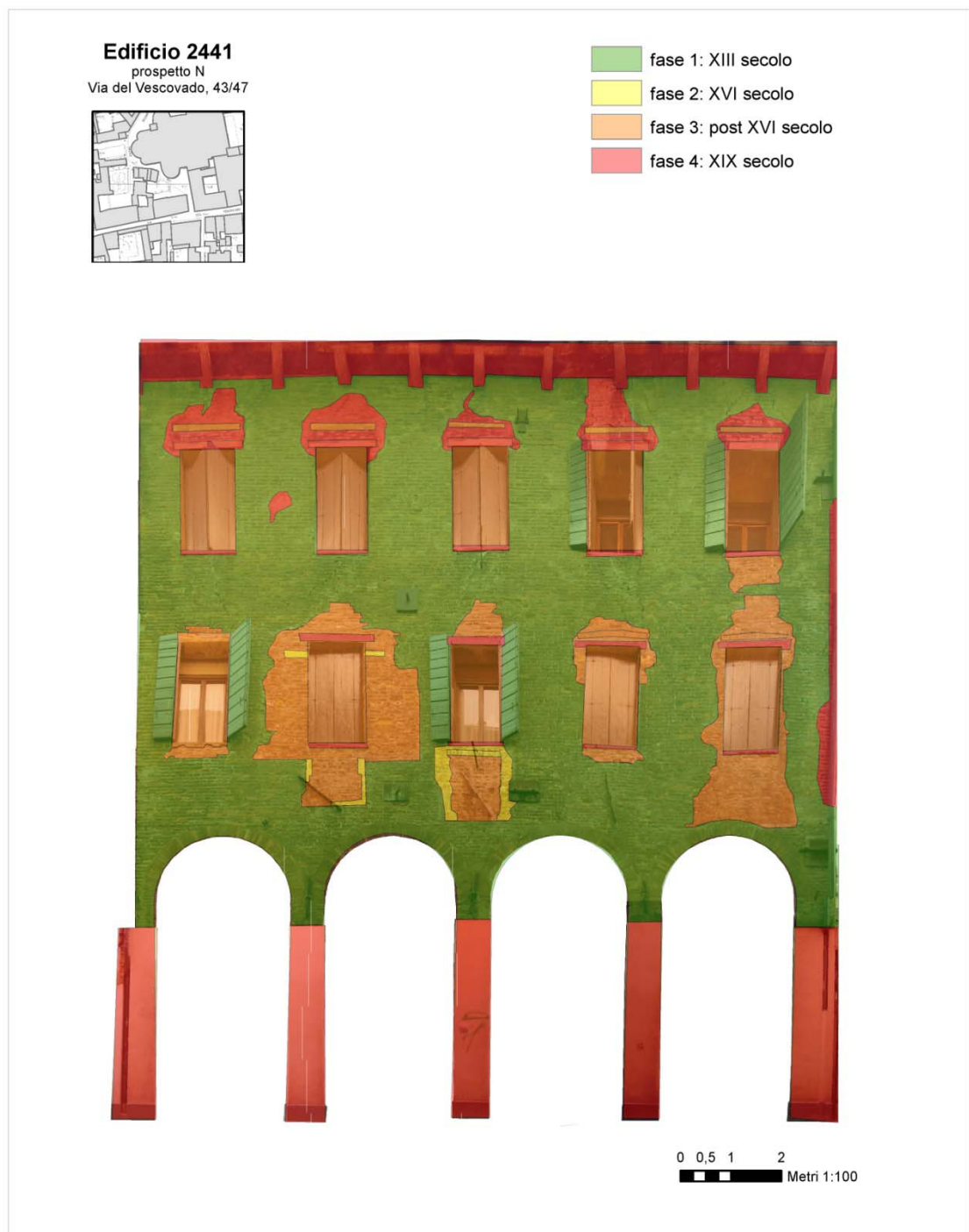
Figura 61: pianta di fase dell'edificio 2441.
