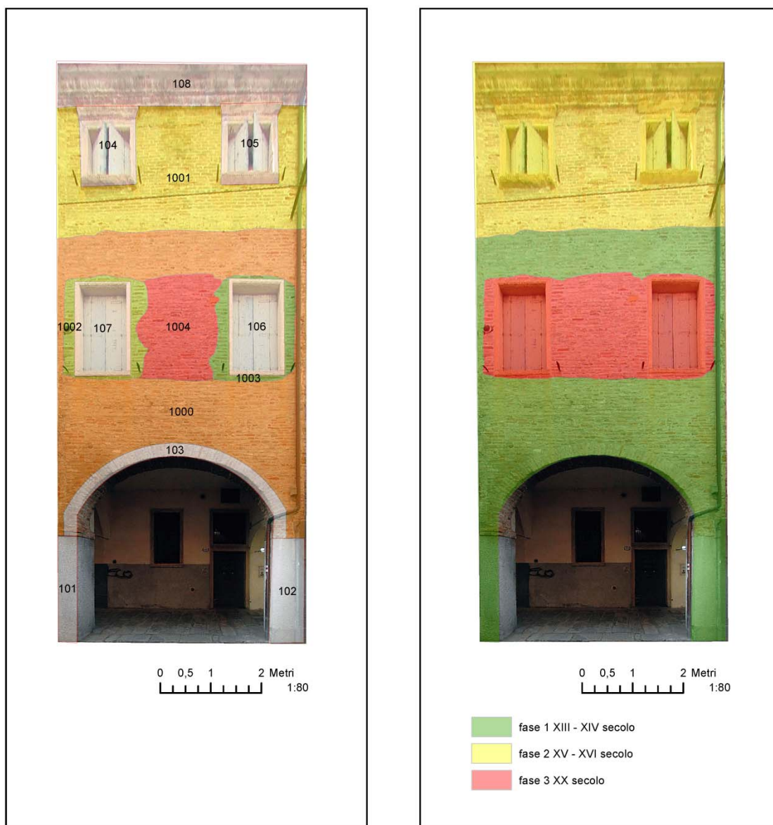
Figura 54: analisi stratigrafica e pianta di fase dell'edificio 3105.
