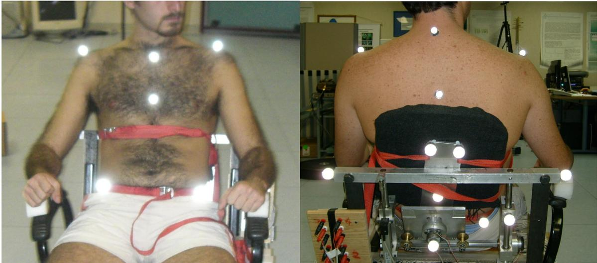
Figura 32 - Posizionamento dei Marker sul soggetto in prova e sul dispositivo potenziometrico
