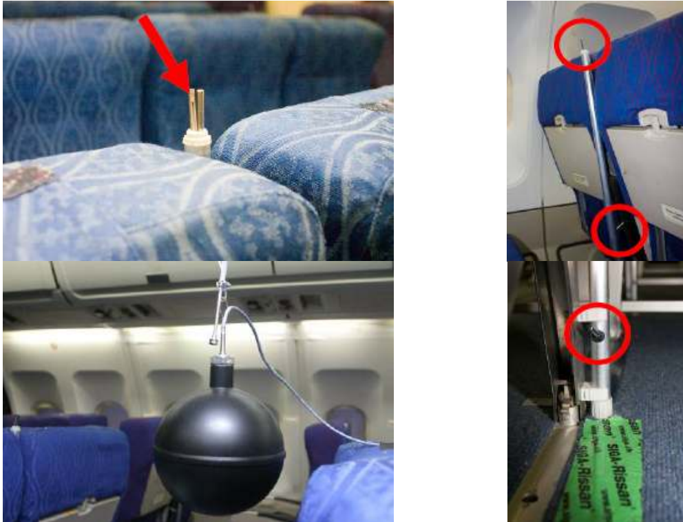
Figura 9.4. Collocazione della strumentazione a bordo della cabina. Dall'alto a sinistra in senso orario: umidità relativa, temperatura dell'aria (110 cm e 60 cm), temperatura radiante e velocità dell'aria (10 cm).
