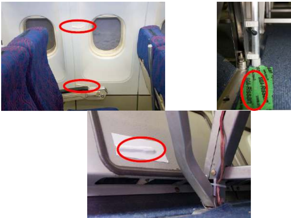
Figura 9.5. Collocazione della strumentazione a bordo della cabina. Dall'alto a sinistra in senso orario: temperatura superficiale delle pareti (110 cm e 60 cm), temperatura del pavimento, temperatura superficiale delle pareti (10 cm).
