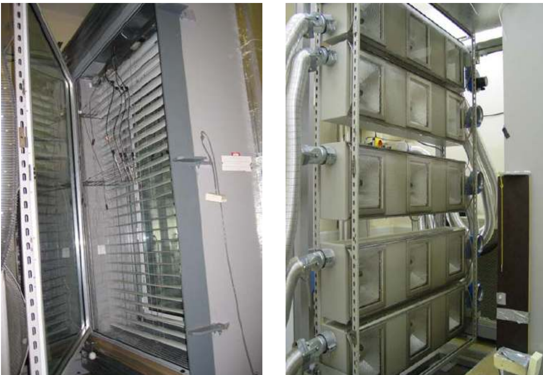
Figura 3.3. Immagine che riporta l'apparato sperimentale. Le simulazioni numeriche hanno riguardato il caso per il quale l'intercapedine era sprovvista di veneziana. A destra, la disposizione delle lampade con le quali è stato simulato l'irraggiamento solare incidente sulla facciata.
