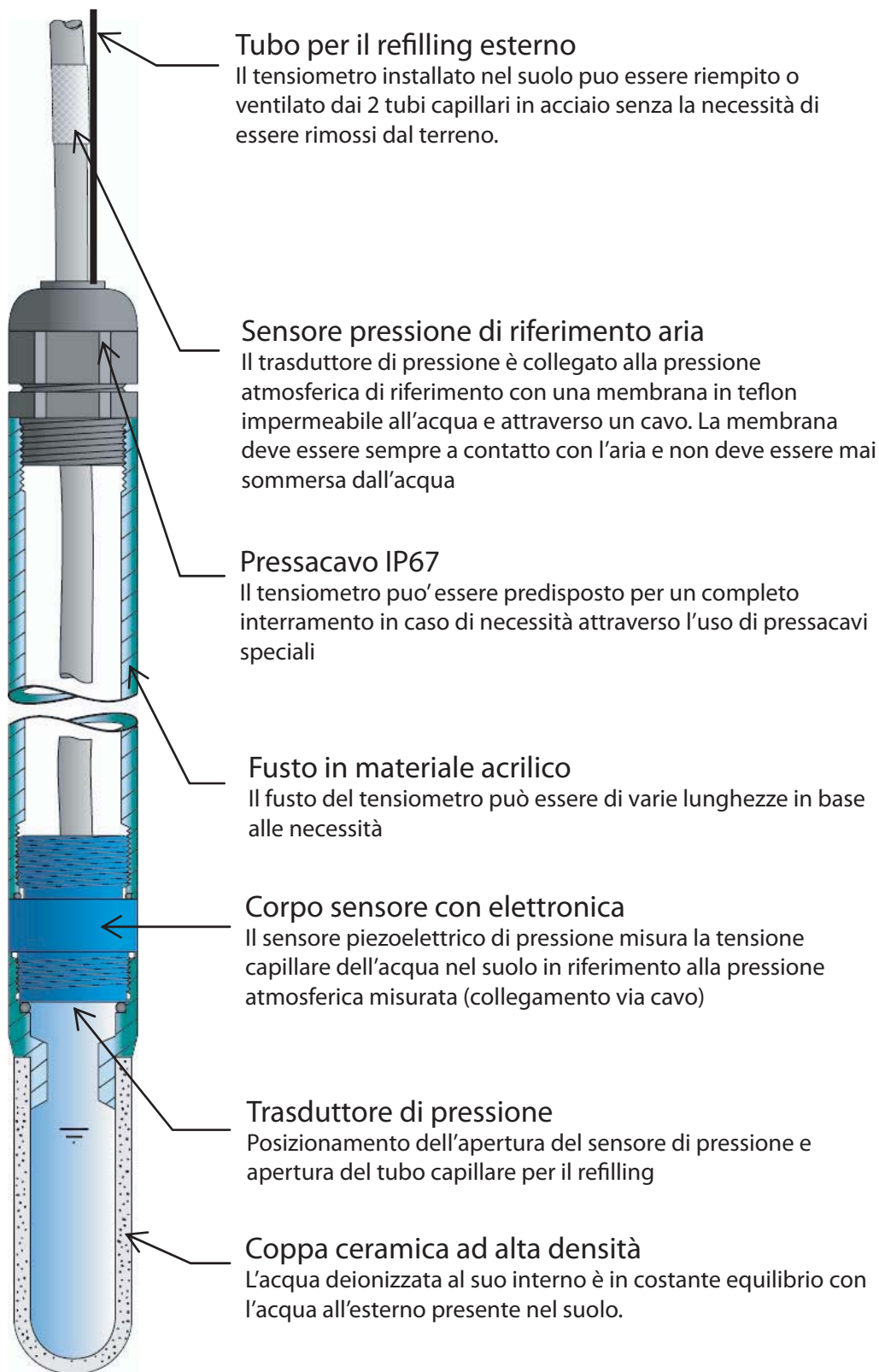
Figura 3.3: Schema e descrizione schematica delle parti che compongono un moderno tensiometro [T4e ditta: UMS (D)]
