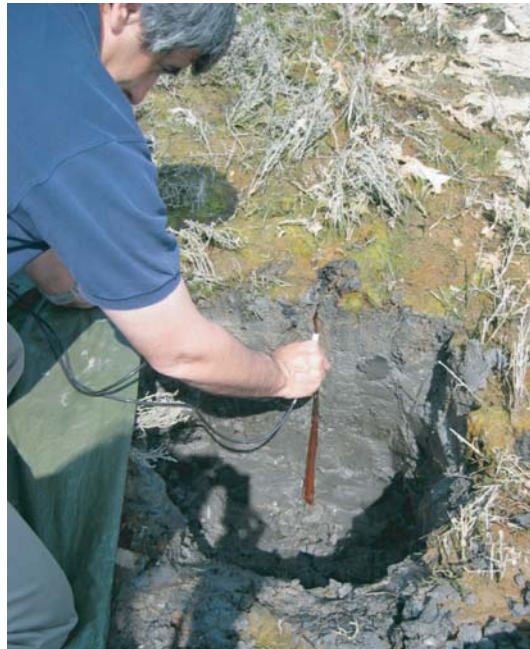
(c) Installazione sensore di temperatura STP01
