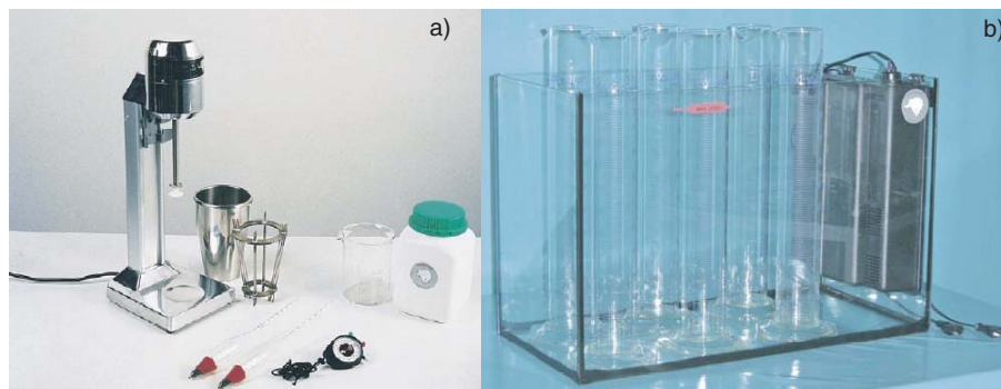
Figura 3.13: a) Agitatore e palette, densimetri, cronometro e esametafosfato di sodio. b) vasca termostatica con cilindri da un litro
