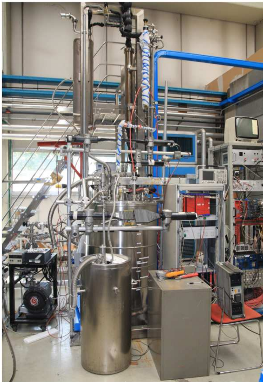
Figura 2.19: Foto dell'apparato sperimentale Icarino ai LNL. Si notano i contatori a scintillazione utilizzati per il trigger esterno per l'acquisizione di eventi di muoni cosmici.
