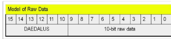
Figura 5.8: Modello raw-data memorizzati nel chip Super-Daedalus.
