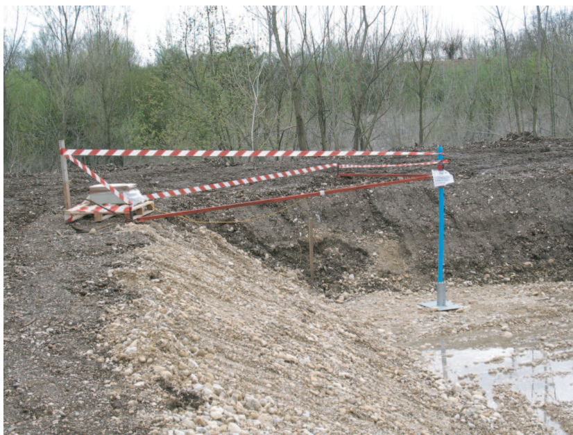
Figura 2.36: Asta idrometrica dotata di sonda per la misura del battente in continuo.
