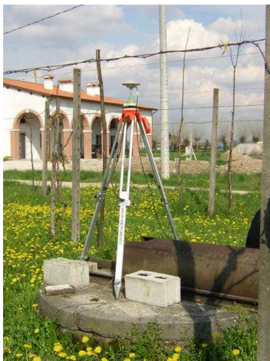
Figura 1.8: Rilevamento delle coordinate geografiche ( x , y e quota b.p.) di un pozzo tramite GPS (pozzo M2).
