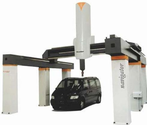
struttura a ponte, tipo Gantry
