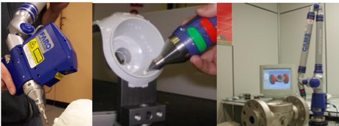
Figura 2-13 - Braccio di misura articolato con sonda a contatto e con sonda laser
