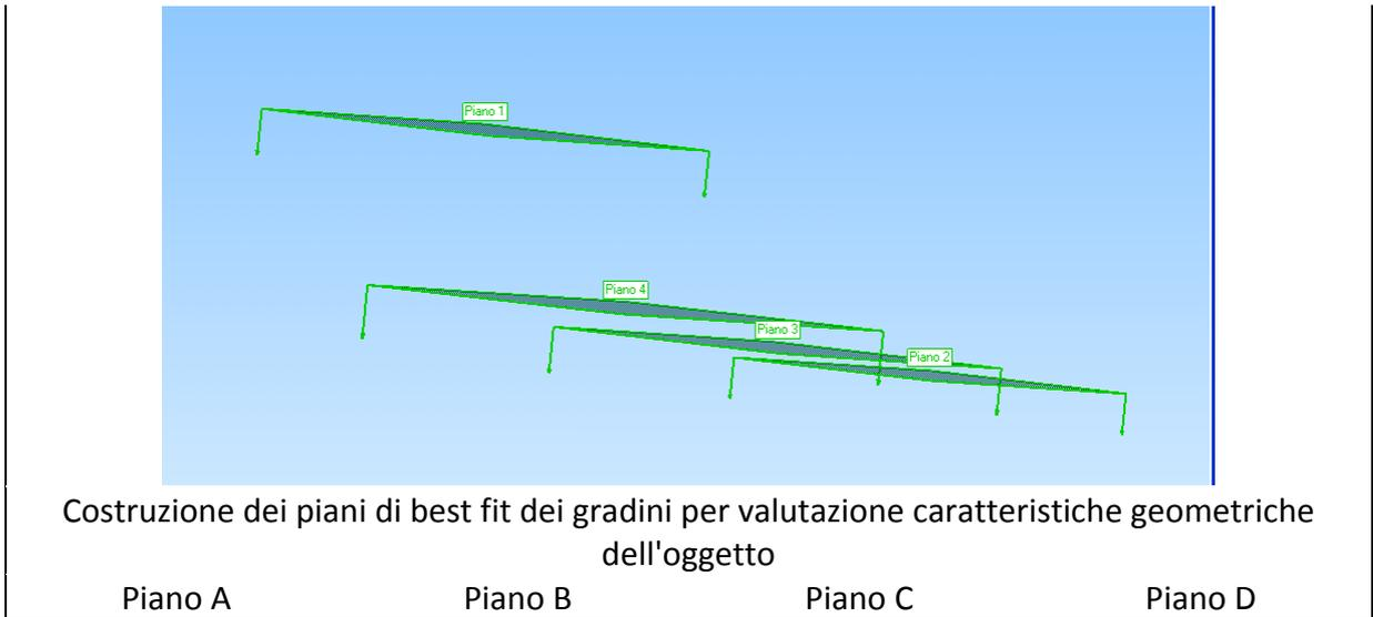
Figura 4-35 - Fasi di costruzione dei piani di best fit a partire dalla nuvola di punti acquisiti con la sonda laser
