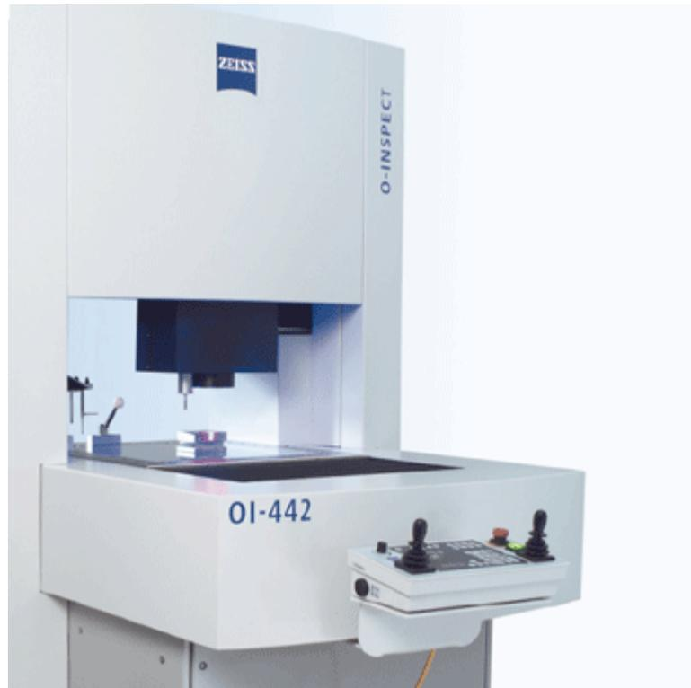
Figura 2-12 - CMM con sensore ottico
