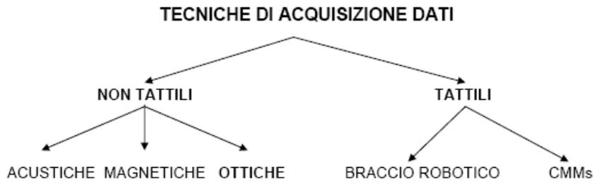
Figura 2-1 - Schema delle tecniche di acquisizione
