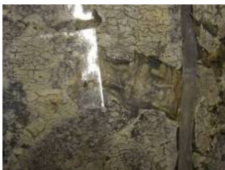
Fig. 8.28: Immagine della superficie del verso della tessera: è visibile il polimero ormai secco e crepato
