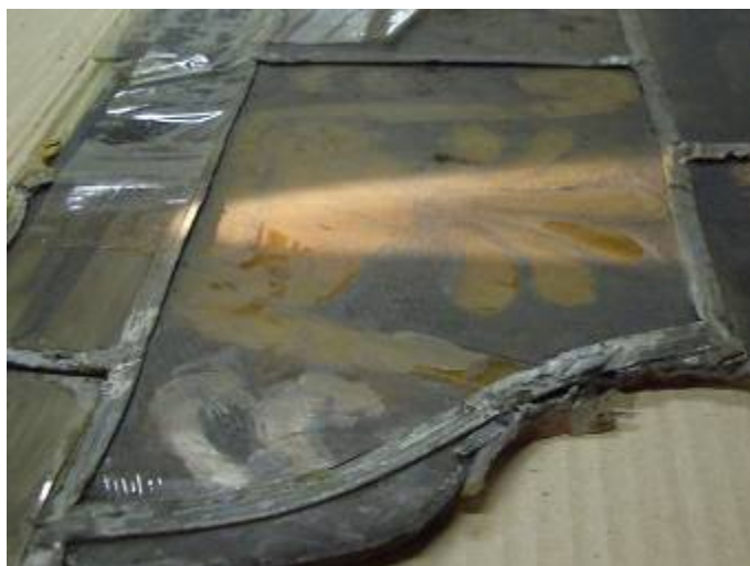
Fig. 8.31: Immagine del verso della tessera 18. E' visibile il sottile strato di paraloid applicato sulla superficie.
