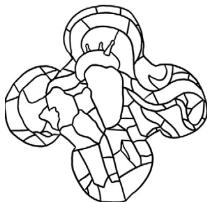
Rilievo del tracciato della tramatura plumbea
