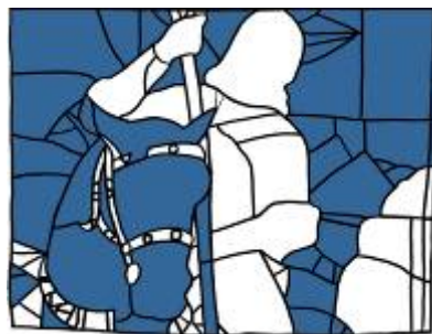
Rilievo del fenomeno di esfoliazione delle grisaglie
