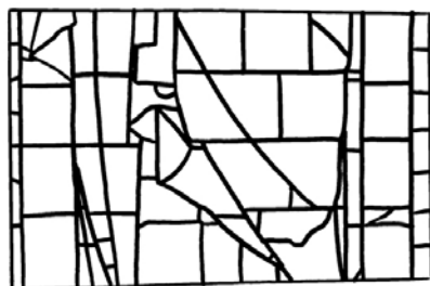
Rilievo del tracciato della tramatura plumbea
