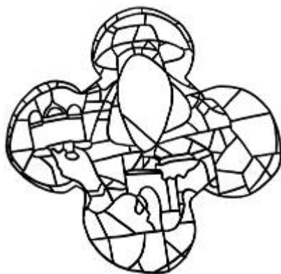
Rilievo del tracciato della tramatura plumbea
