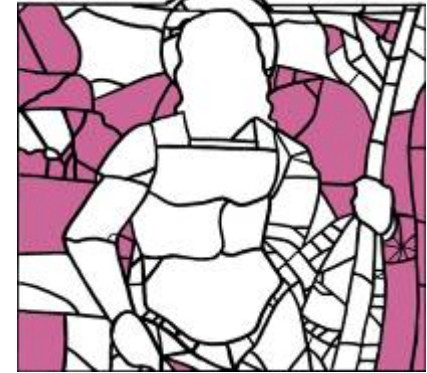
Rilievo delle tessere sostituite nel 1908
