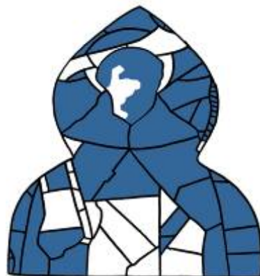
Rilievo del fenomeno di esfoliazione delle grisaglie
