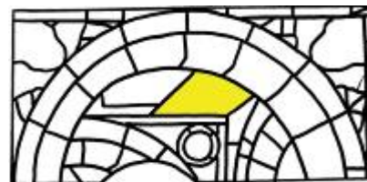
Rilievo del fenomeno di distacco delle grisaglie
