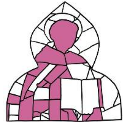
Rilievo delle tessere sostituite nel 1908
