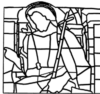
Rilievo del fenomeno di distacco delle grisaglie
