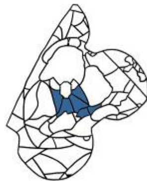
Rilievo del fenomeno di esfoliazione delle grisaglie
