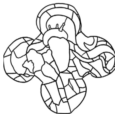
Rilievo del fenomeno di distacco delle grisaglie
