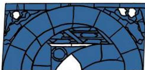
Rilievo del fenomeno di esfoliazione delle grisaglie
