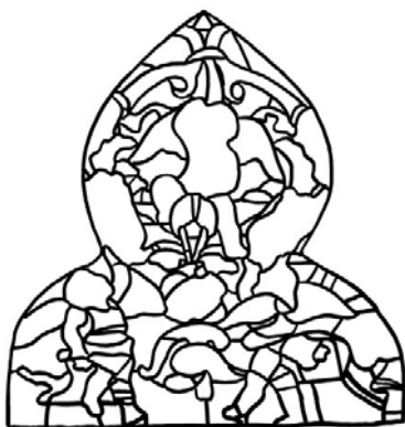
Rilievo del tracciato della tramatura plumbea
