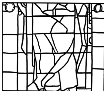
Rilievo del tracciato della tramatura plumbea
