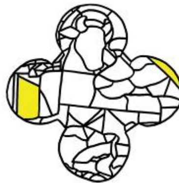
Rilievo del fenomeno di distacco delle grisaglie
