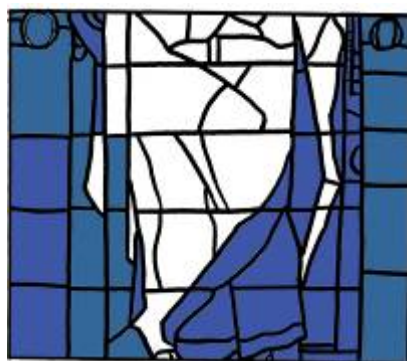
Rilievo del fenomeno di esfoliazione delle grisaglie
