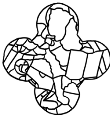
Rilievo del tracciato della tramatura plumbea
