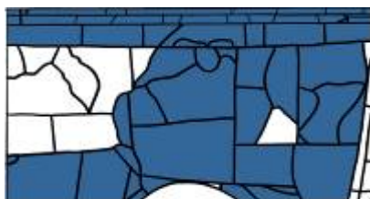
Rilievo del fenomeno di esfoliazione delle grisaglie
