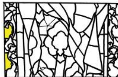
Rilievo del fenomeno di distacco delle grisaglie
