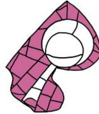
Rilievo delle tessere sostituite nel 1908
