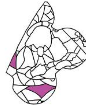
Rilievo delle tessere sostituite nel 1908
