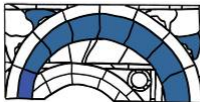
Rilievo del fenomeno di esfoliazione delle grisaglie
