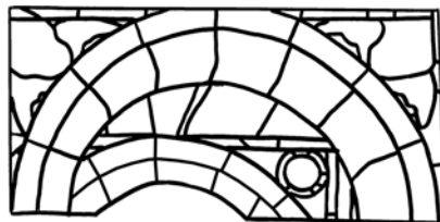
Rilievo del tracciato della tramatura plumbea
