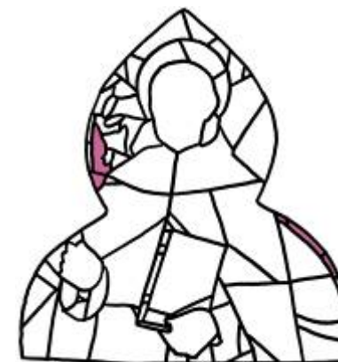
Rilievo delle tessere sostituite nel 1908
