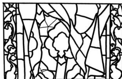
Rilievo del tracciato della tramatura plumbea
