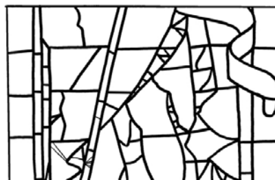
Rilievo del fenomeno di distacco delle grisaglie
