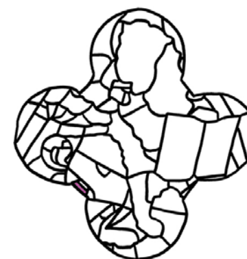
Rilievo delle spanciature verso l'interno ◆◆◆◆ verso l'esterno ◆◆◆◆
