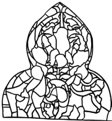
Rilievo del tracciato della tramatura plumbea
