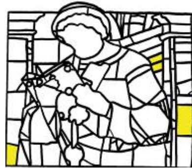
Rilievo del fenomeno di distacco delle grisaglie
