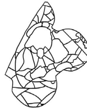
Rilievo del fenomeno di distacco delle grisaglie
