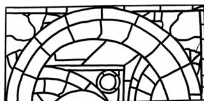
Rilievo del tracciato della tramatura plumbea
