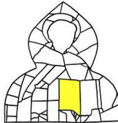
Rilievo del fenomeno di distacco delle grisagle
