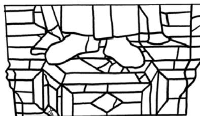
Rilievo del tracciato della tramatura plumbea
