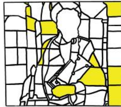
Rilievo del fenomeno di distacco delle grisaglie
