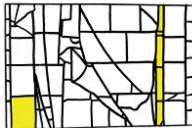
Rilievo del fenomeno di distacco delle grisaglie
