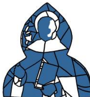
Rilievo del fenomeno di esfoliazione delle grisaglie
