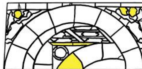
Rilievo del fenomeno di distacco delle grisaglie
