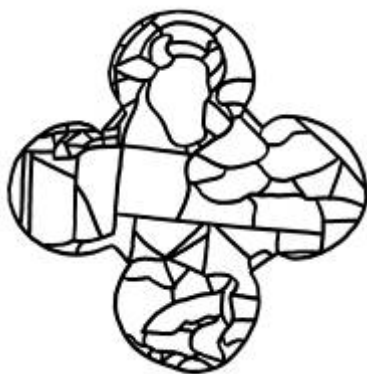
Rilievo del tracciato della tramatura plumbea
