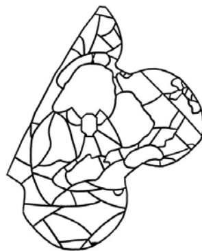
Rilievo del tracciato della tramatura plumbea
