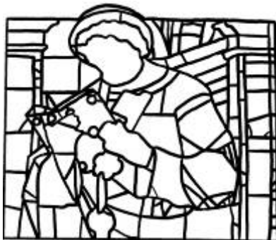
Rilievo del tracciato della tramatura plumbea
