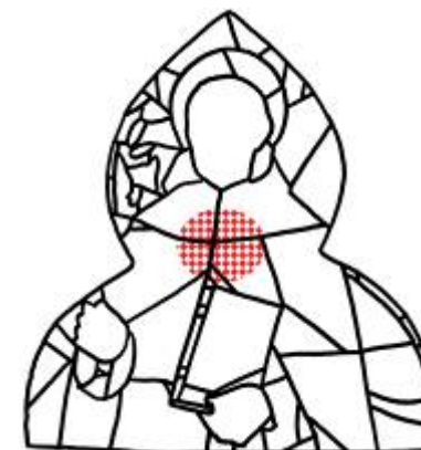
Rilievo delle spanciature verso l'interno ■■■■■ verso l'esterno ■■■■■
