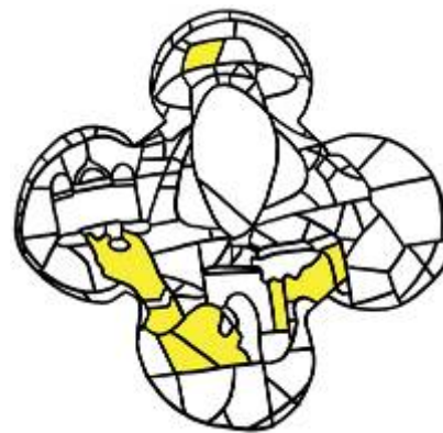
Rilievo del fenomeno di distacco delle grisaglie
