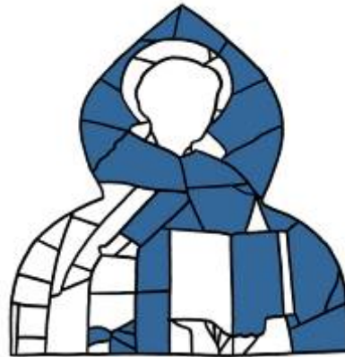
Rilievo del fenomeno di esfoliazione delle grisagle
