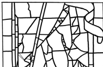
Rilievo del tracciato della tramatura plumbea
