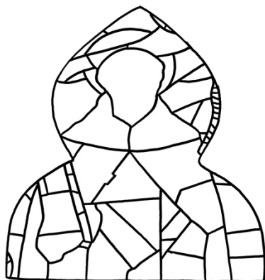
Rilievo del tracciato della tramatura plumbea
