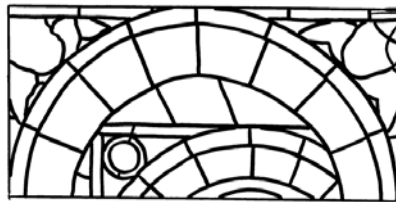
Rilievo del tracciato della tramatura plumbea
