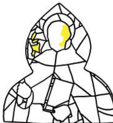
Rilievo del fenomeno di distacco delle grisaglie
