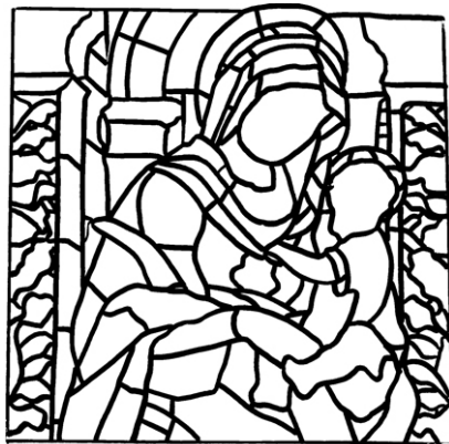
Rilievo del tracciato della tramatura plumbea
