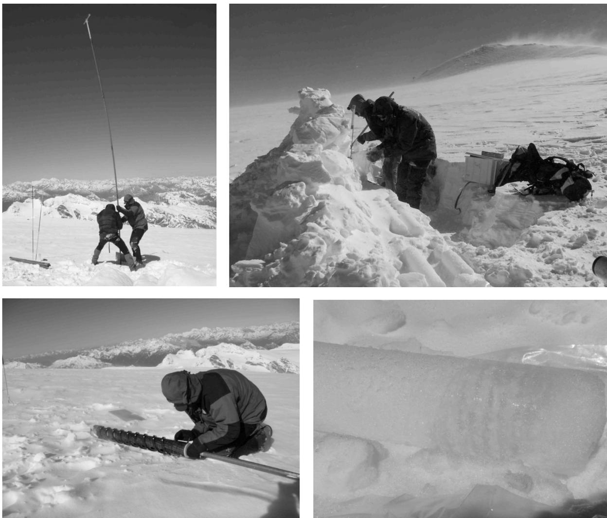
*Figura 28 - Alcune fasi durante le indagini chimico-fisiche eseguite sulla vedretta Alta dell'Ortles il 12-06-2009. In alto a sinistra, si inserisce il carotiere per la perforazione. In alto a destra durante il processamento dei campioni di ghiaccio. In basso a sinistra pulizia del carotiere prima del prelievo del campione di ghiaccio. In basso a destra un campione di firn contenente lenti di ghiaccio.*
