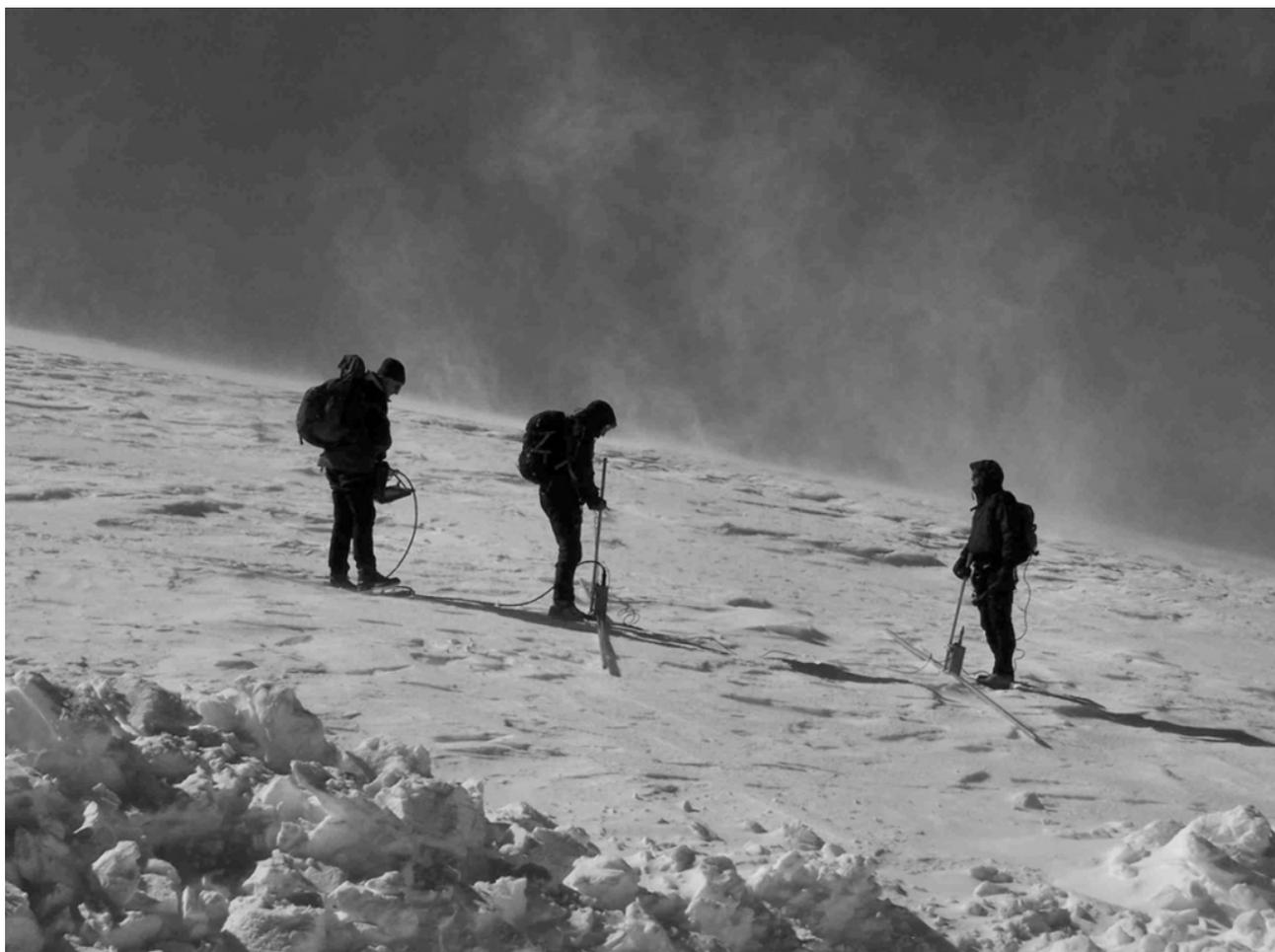
*Figura 29 - Indagini geofisiche con georadar sul settore superiore della vedretta Alta dell'Ortles
