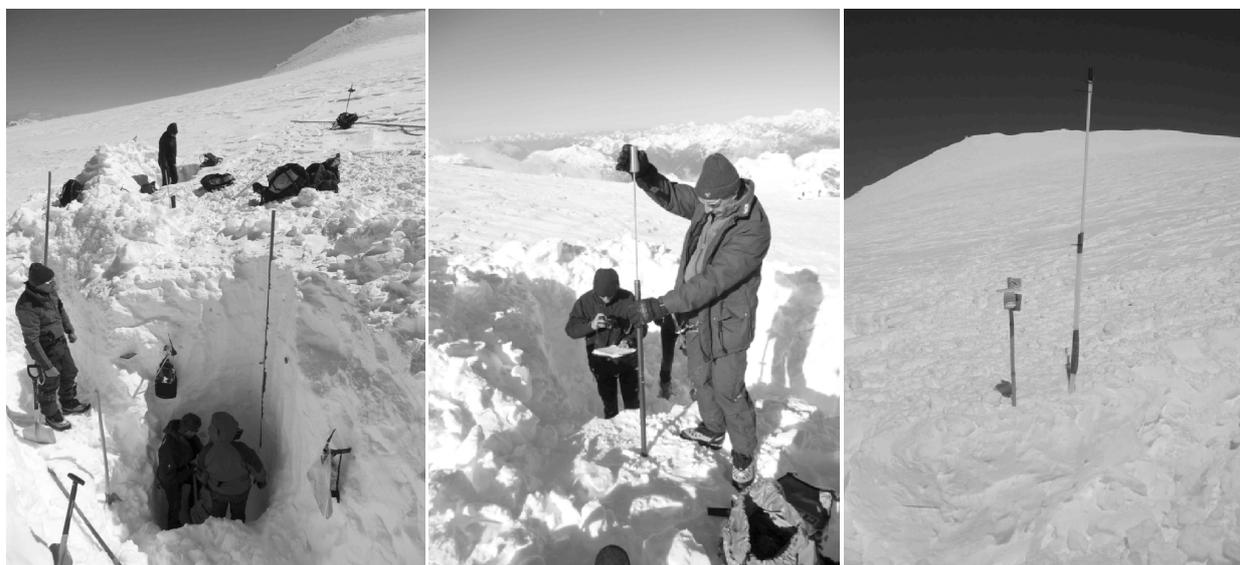
*Figura 27 – A sinistra e al centro misure glaciologiche in trincea; a destra le due paline di ablazione installate nei pressi della cima dell'Ortles (www.ortles.org).*
