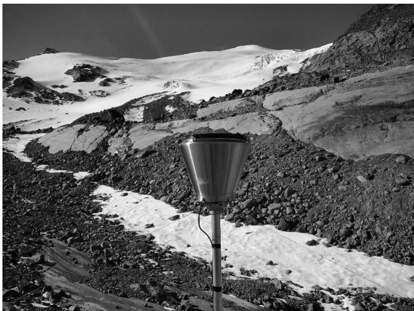
*Figura 22 - Il pluviometro installato a breve distanza dall'AWS del ghiacciaio de La Mare, su roccia in posto.*
