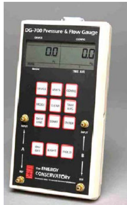
Fig. 3.3.2: data logger che rileva la misura di pressione tra interno ed esterno e la portata d'aria attraverso il ventilatore.
