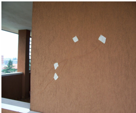
Fig. 2.7.2: esempi di installazione della strumentazione per le misure di conduttanza in opera: (A) piastra e termocoppie lato interno, (B) e (C) termocoppie lato esterno.
