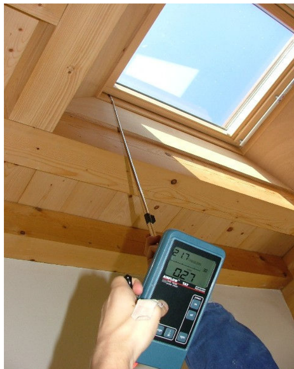
Fig. 3.3.3: termo-anemometro a filo caldo, per la misura di temperatura e l'indagine di velocità dell'aria.
