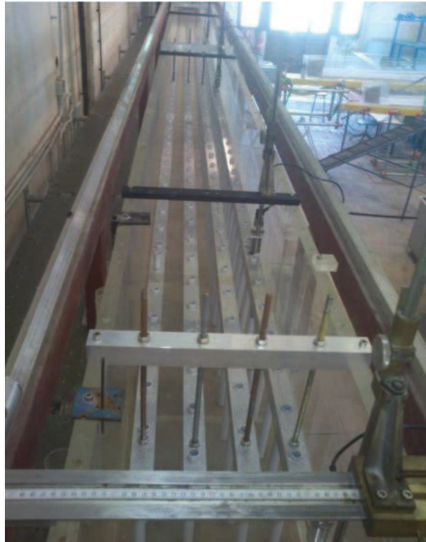
Fig. 15 Canaletta grande: supporto metallico, sbarre in alluminio e cilindri in PVC
