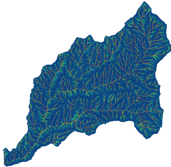
Figura 4.7: Mappa del deflusso superficiale risultante dall'applicazione del modello idrologico.
