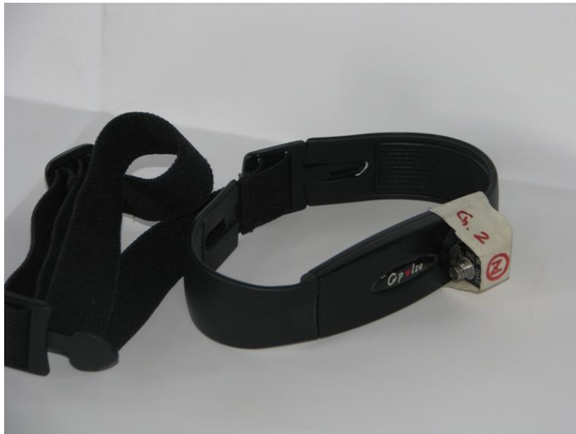
Figura 2.16 Fascia elastica dotata di accelerometro per la misura dell'accelerazione del torace
