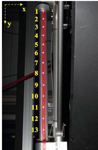
Fig. 4.32: Posizionamento dei marker sull'albero di supporto della miniturbina (laterale).
