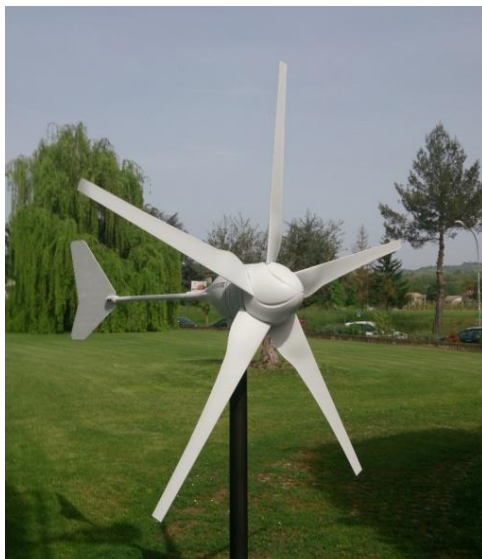
Figura 2.12: turbina micro eolica
