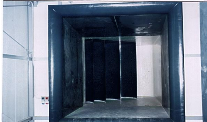
Figura 3.5: diffusore della galleria del vento subsonica
