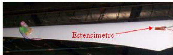
Fig. 4.5: Posizione dell'estensimetro nella prova dinamica
