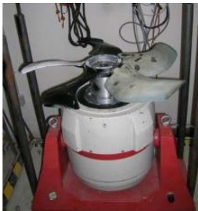
Fig. 4.19: la ventola vincolata rigidamente alla testa dello shaker.
