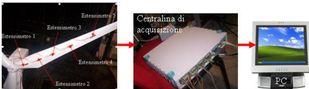
Fig. 4.1: Catena di misura delle prove estensimetriche
