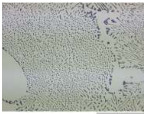
Fig. 1.1: la microstruttura di Magsimal ® -59. 1000X.
