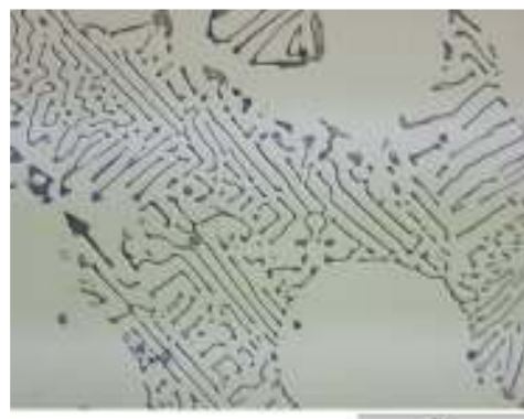
Fig. 1.2: la microstruttura di una comune AlMg5Si2Mn. 1000X.
